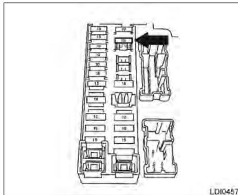
Se qualquer equipamento elétrico não funcionar, verifique se algum fusível está queimado.
