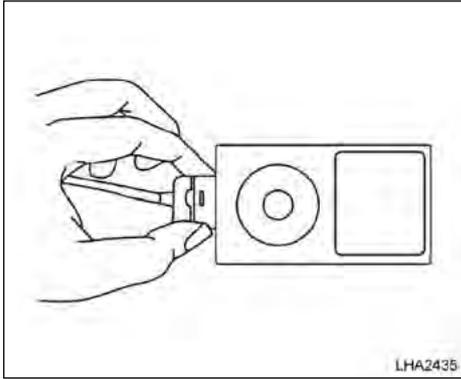
Para desconectar o cabo do iPod, pressione as presilhas e puxe o conector do cabo do iPod para fora do dispositivo.
