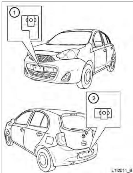
Instale a placa de licença dianteira no suporte da placa de licença ① e a placa de licença traseira no suporte da placa de licença ②, usando dois parafusos M6-14 mm (não fornecidos) para rosquear nas porcas. Centralize a placa de licença no suporte e aperte firmemente.
