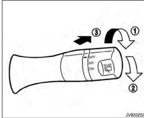
O limpador e o lavador do vidro traseiro funcionam quando o interruptor de ignição estiver na posição ON.
