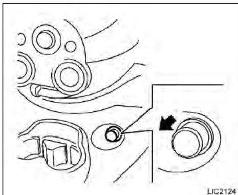
A tomada de força é destinada a fornecer energia para acessórios, tais como telefones celulares. Sua capacidade máxima é de 12 volts, 120 W (10A).
