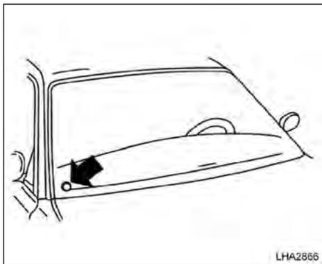
O sensor de carga solar (se equipado), localizado na parte superior no lado do passageiro do painel de instrumentos, ajuda o sistema a manter uma temperatura constante. Não coloque nenhum objeto sobre ou ao redor do sensor.
