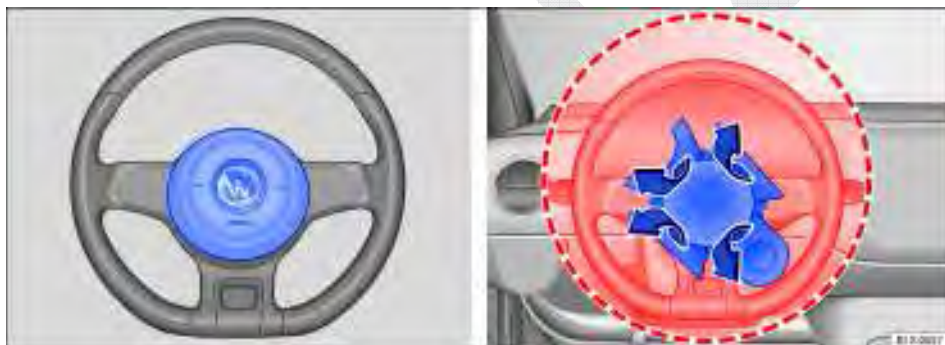
Fig. 47 Local de instalação e área de expansão do airbag frontal do condutor.
