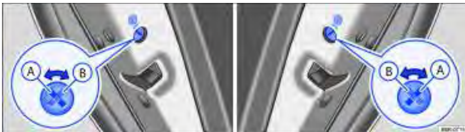
Fig. 53 Nas portas traseiras: trava de segurança para crianças (A) desacionada, (B) acionada.
