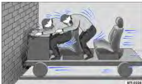
Fig. 38 Um veículo com os ocupantes do veículo sem cintos de segurança colide com o muro.
