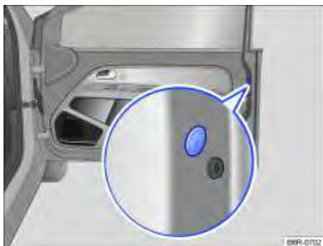
Fig. 132 Na parte dianteira da porta do passageiro dianteiro: travamento de emergência, coberto por uma vedação de borracha.
