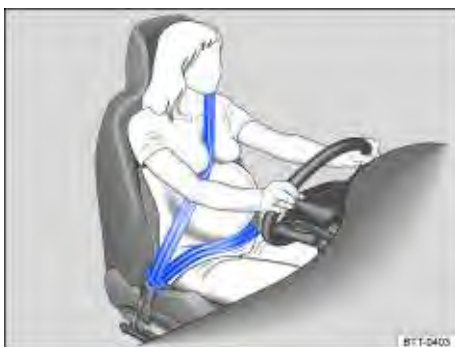
Fig. 45 Posição correta do cadarço do cinto de segurança para mulheres grávidas.
