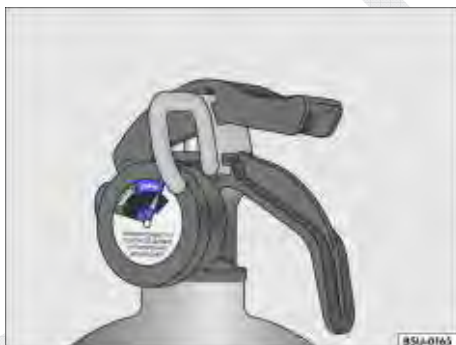
Fig. 130 No extintor de incêndio: indicador de carga (manômetro).
