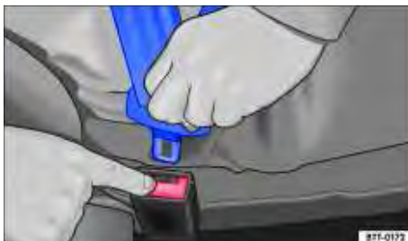
Fig. 43 Soltar a lingueta do cinto de segurança do fecho do cinto de segurança.
