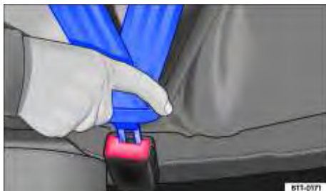
Fig. 42 Introduzir a lingueta do cinto de segurança no fecho do cinto de segurança.
