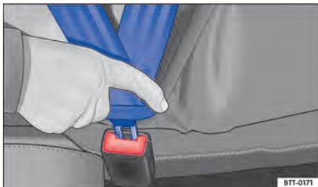
Fig. 40 Introduzir a lingueta do cinto de segurança no fecho do cinto de segurança.
