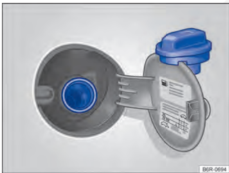
Fig. 100 Portinhola do tanque de combustível aberta com a tampa do tanque de combustível pendurada.
