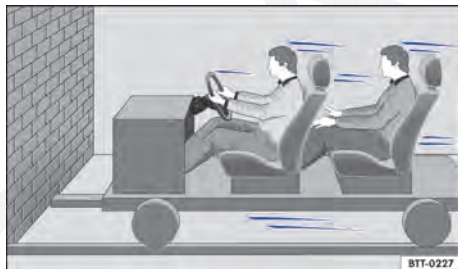
Fig. 35 Um veículo com os ocupantes do veículo sem cintos de segurança está em rota de colisão com um muro.
