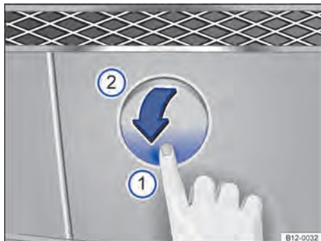
Fig. 152 No para-choque dianteiro à direita: soltar e remover a cobertura.
