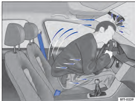
Fig. 37 O condutor sem cinto de segurança é lançado para frente.
