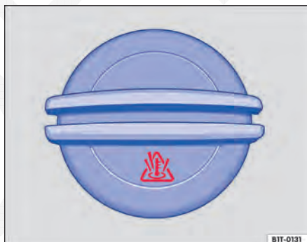
Fig. 106 No compartimento do motor: tampa do reservatório de expansão do líquido de arrefecimento do motor.
