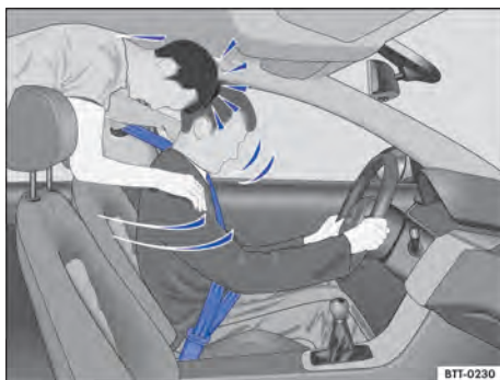
Fig. 38 O passageiro sem cinto de segurança no banco traseiro é lançado para frente sobre o condutor com cinto de segurança.
