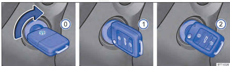
Fig. 81 Ao lado do volante, à direita: posições da chave do veículo no cilindro da ignição.
