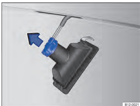
Fig. 150 Lanterna da placa de licença: remover o soquete da lâmpada.
