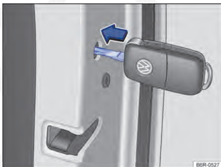
Fig. 129 Travamento de emergência do veículo com a chave do veículo.
