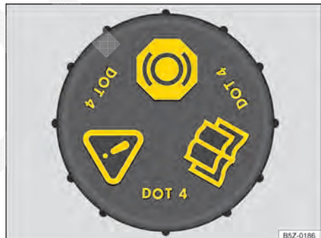
Fig. 91 No compartimento do motor: tampa do reservatório de fluido de freio (variante 2).
