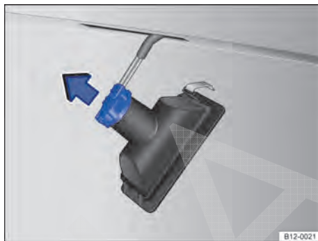
Fig. 152 Lanterna da placa de licença: remover o soquete da lâmpada.
