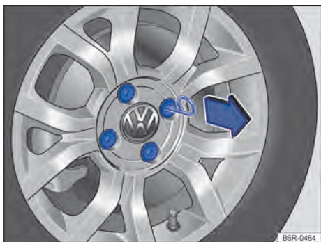
Fig. 137 Retirar as capas de cobertura dos parafusos da roda.
