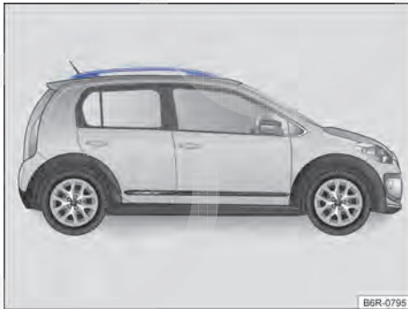
Fig. 70 Suportes longitudinais do bagageiro do teto (ambos os lados).
