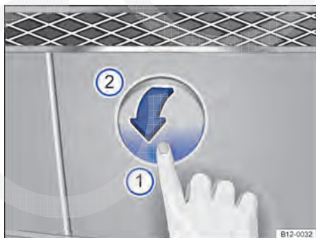
Fig. 154 No para-choque dianteiro à direita: soltar e remover a cobertura.
