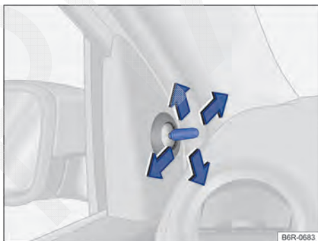
Fig. 61 Nas portas dianteiras: botão de ajuste dos espelhos retrovisores externos mecânicos.
