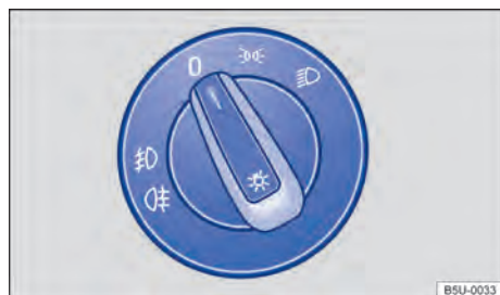
Fig. 55 No painel: interruptor das luzes. ▶
