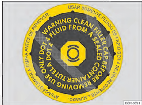
Fig. 90 No compartimento do motor: tampa do reservatório de fluido de freio (variante 1).
