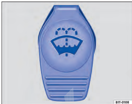
Fig. 59 No compartimento do motor: tampa do reservatório de água dos lavadores dos vidros.
