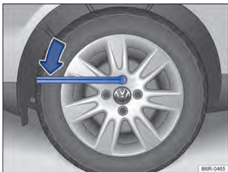
Fig. 138 Troca de roda: soltar os parafusos da roda.
