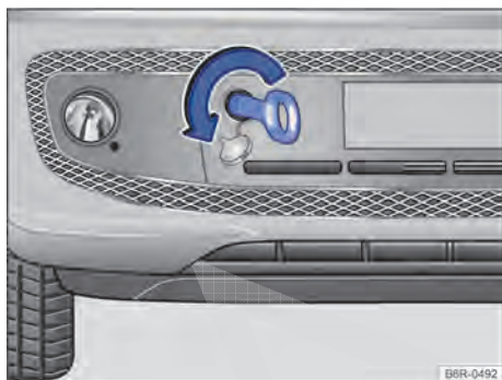
Fig. 155 No para-choque dianteiro à direita: rosquear a argola de reboque.
