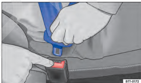
Fig. 42 Soltar a lingueta do cinto de segurança do fecho do cinto de segurança.
