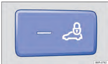
Fig. 19 Luz de controle no painel de instrumentos para indicação do travamento central acionado e/ou indicação do monitoramento do interior do veículo desligado.
