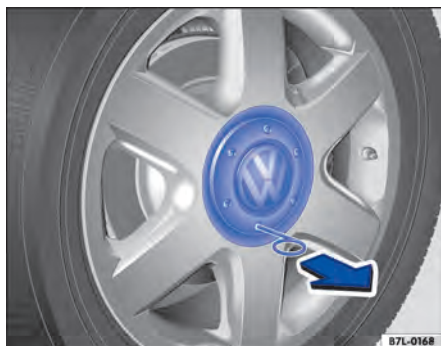
Fig. 135 Retirar a calota central da roda de liga leve.
