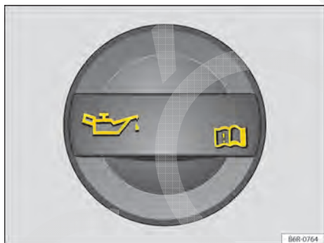
Fig. 106 No compartimento do motor: tampa da abertura para enchimento de óleo do motor.
