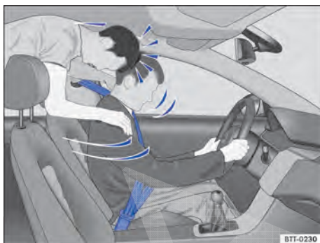
Fig. 39 O passageiro sem cinto de segurança no banco traseiro é lançado para frente sobre o condutor com cinto de segurança.
