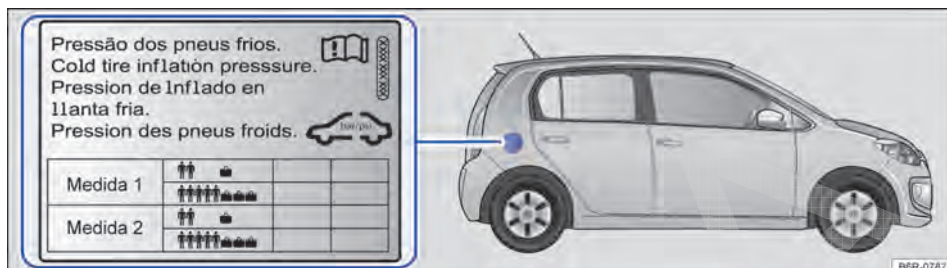
Fig. 116 Na parte interna da portinhola do tanque de combustível: etiqueta com a pressão dos pneus.
