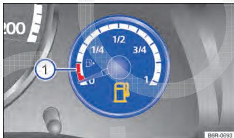
Fig. 101 No instrumento combinado: indicador do nível de combustível (variante 2).
