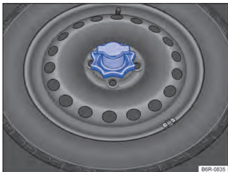
Fig. 140 No compartimento de bagagem: manípulo para fixação da roda de emergência.
