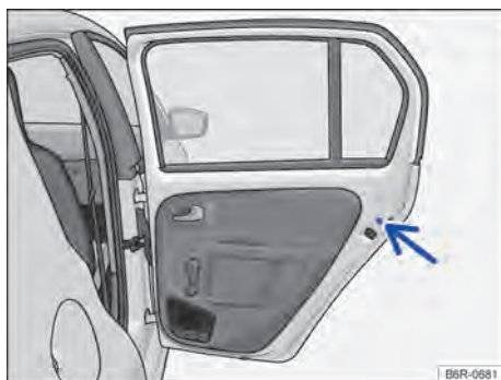
Fig. 38 Na porta traseira (lado direito): localização da trava de segurança para crianças.
