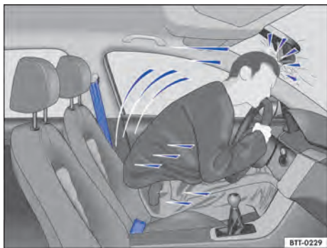
Fig. 23 O condutor sem cinto de segurança é lançado para frente.
