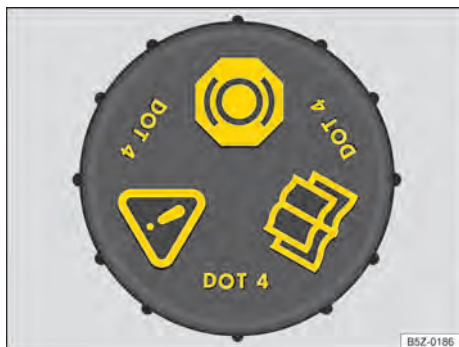
Fig. 134 No compartimento do motor: tampa do reservatório de fluido de freio (variante 2).
