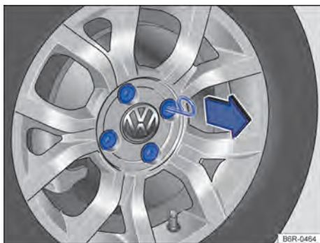
Fig. 144 Retirar as capas de cobertura dos parafusos da roda.
