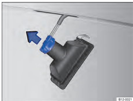
Fig. 116 Lanterna da placa de licença: remover o soquete da lâmpada.
