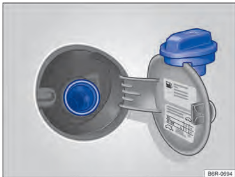
Fig. 104 Portinhola do tanque de combustível aberta com a tampa do tanque de combustível pendurada.
