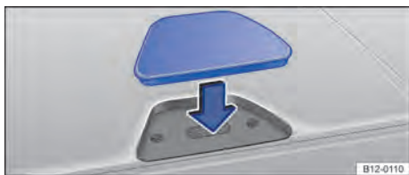
Fig. 148 No console central: fechar a abertura do suporte para telefone celular.
