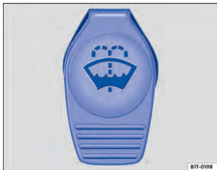
Fig. 128 No compartimento do motor: tampa do reservatório de água dos lavadores dos vidros.
