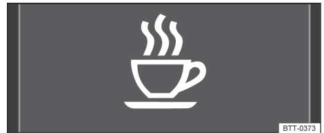
Fig. 12 No display do instrumento combinado: símbolo do sistema de reconhecimento de cansaço.
