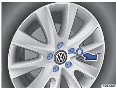
Fig. 165 Remover as capas de cobertura dos parafusos de roda.
