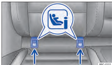
Fig. 44 No banco do veículo: identificação dos pontos de ancoragem inferiores para cadeiras de criança.
