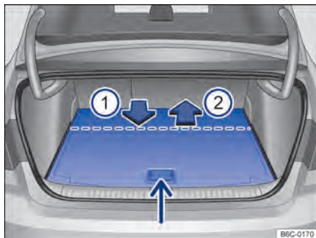
Fig. 117 No compartimento de bagagem: ajustar a altura do assoalho variável do compartimento de bagagem.
