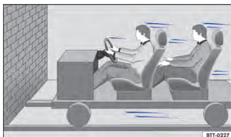
Fig. 26 Um veículo com os ocupantes do veículo sem cintos de segurança está em rota de colisão com um muro.
