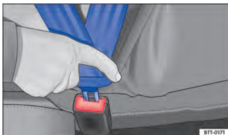
Fig. 31 Introduzir a lingueta do cinto de segurança no fecho do cinto de segurança.
