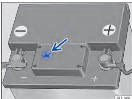
Fig. 156 No compartimento do motor: exemplo de posição do visor no lado superior da bateria do veículo.
