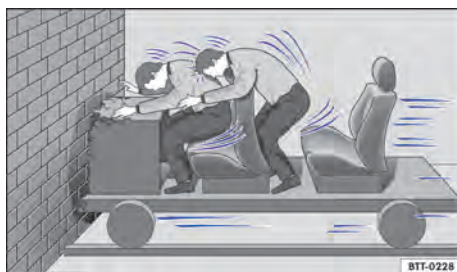
Fig. 27 Um veículo com os ocupantes do veículo sem cintos de segurança colide com o muro.
