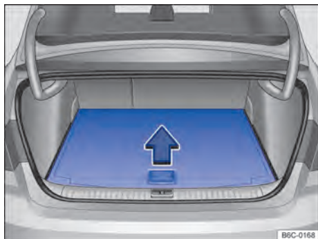
Fig. 116 No compartimento de bagagem: levantar o assoalho variável do compartimento de bagagem.
