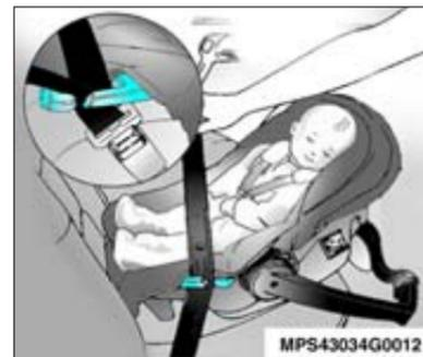
Mova o ajuste de altura do cinto de segurança do veículo para a posição mais baixa. Puxe o cinto e posicione-o nos encaixes laterais da estrutura do assento. Afivele o cinto de segurança do veículo.
