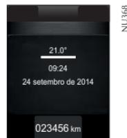
Ao ligar o veículo (chave de ignição em **MAR**), será visualizado os dados presentes antes do último desligamento. Se o display apresentava dados do hodômetro total antes do desligamento (Chave em **STOP**), então, este permanecerá no display.
