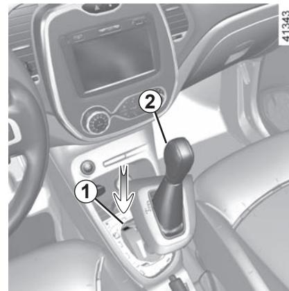
Se a alavanca ficar bloqueada em **P** mesmo com o pé no pedal do freio, é possível liberar manualmente a alavanca. Para fazer isso, desencaixe a base da alavanca, depois insira uma ferramenta (com uma haste rígida) na abertura **1** e pressione o botão **2** ao mesmo tempo a fim de desbloquear a alavanca.
