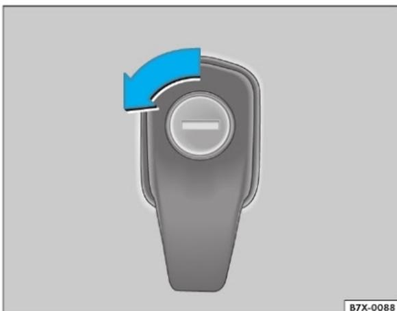
Fig. 28 Tampa do compartimento de bagagem: fechamento
