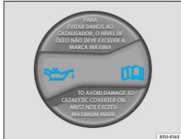
**Fig. 65** No compartimento do motor: tampa do bocal de abastecimento de óleo
