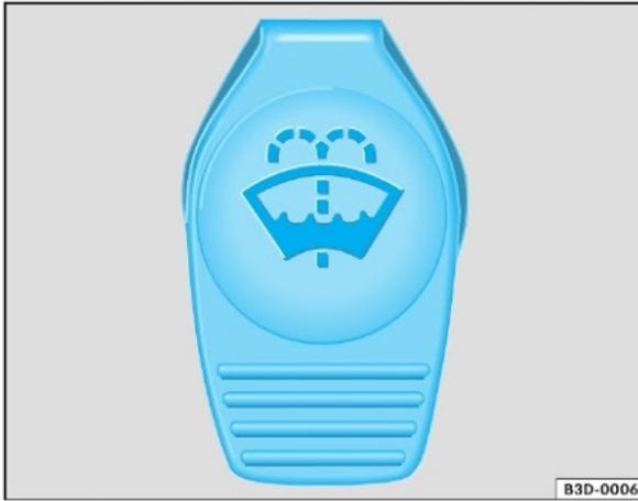
**Fig. 68** Tampa do reservatório do limpador do para-brisa
