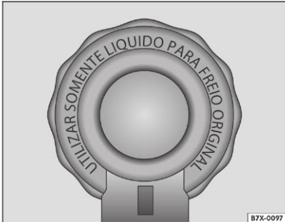
**Fig. 70** Tampa do reservatório do fluido dos freios
