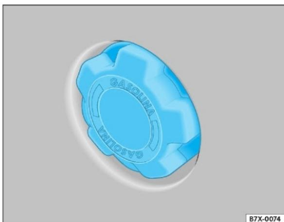
Fig. 71 Reservatório do sistema de partida a frio
