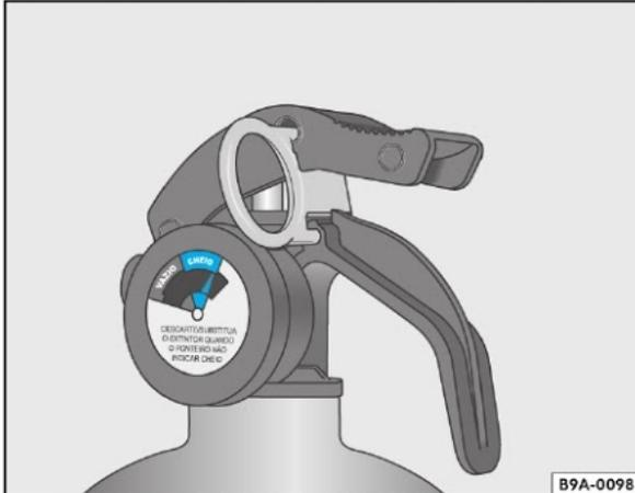
**Fig. 75** Manômetro: indicador de carga
