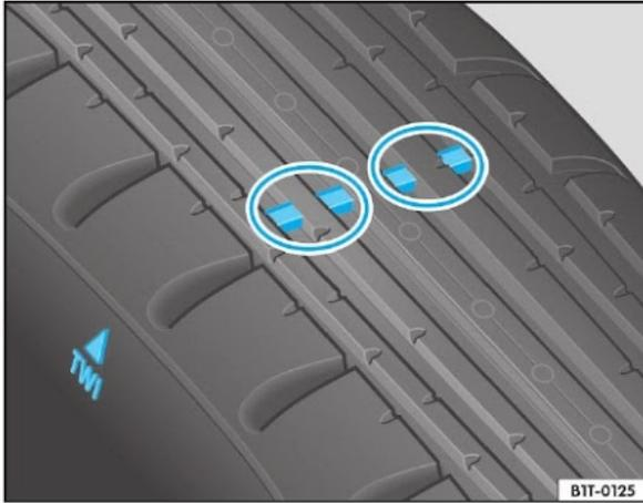
**Fig. 73** Representação do perfil do pneu: indicadores de desgaste
