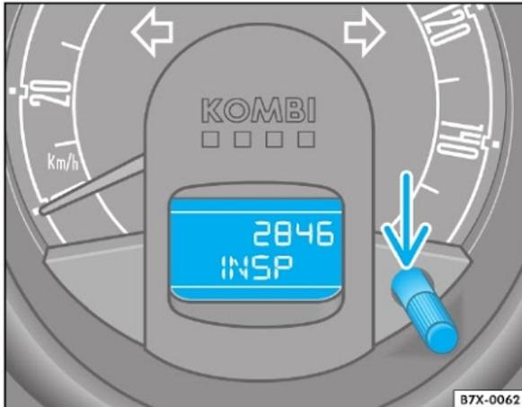
**Fig. 22** Detalhe no painel de instrumentos: indicador do próximo serviço
