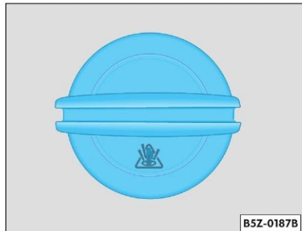
**Fig. 67** No compartimento do motor: remover a tampa do reservatório do líquido de arrefecimento
