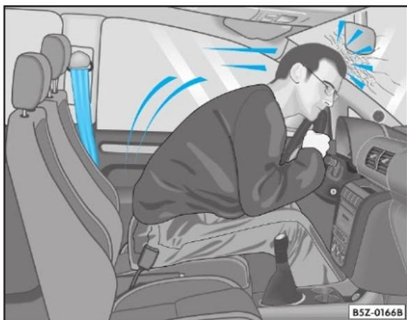
**Fig. 5** O condutor que não colocou o cinto de segurança é projetado violentamente para a frente
