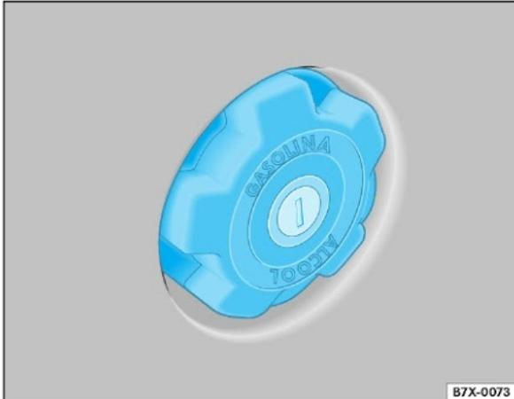
**Fig. 62** Bocal de abastecimento e tampa do reservatório de combustível
