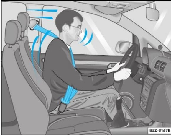
**Fig. 7** Condutor protegido pelo cinto de segurança corretamente colocado durante uma freada brusca
