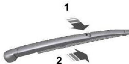
3. Para remover a palheta do limpador, pressione o adaptador de plástico (1) e puxe (2) a palheta do limpador.
