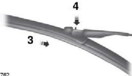
1. Para montar a palheta do limpador, deslize (3) a palheta nova no braço do limpador até você ouvir um clique de encaixe (4).
