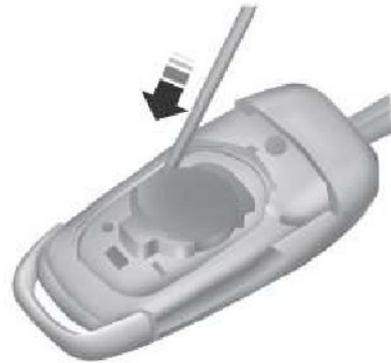
**Nota:** Não toque nos contatos da bateria ou na placa de circuito impresso com a chave de fenda.
