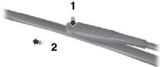
3. Para remover a palheta do limpador, pressione o adaptador de plástico (1) e puxe (2) a palheta do limpador.
