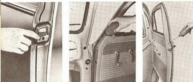
Para os cilindros das fechaduras, emprega-se grafite em pó. Basta soprar no seu interior uma pequena quantidade, girando-se em seguida a chave várias vezes.
