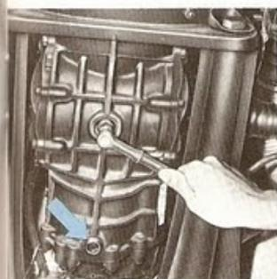
Os bujões magnéticos de escoamento, devem ser limpos depois de rodados os 500 e 2.500 km iniciais. Posteriormente a cada 2.500 km. Para manter as propriedades especiais do óleo para engrenagem, evite usar mais de uma marca de óleo.
