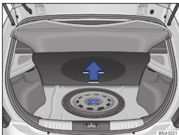
Fig. 103 No compartimento de bagagem, sob o revestimento de assoalho: roda de emergência e ferramentas de bordo.
