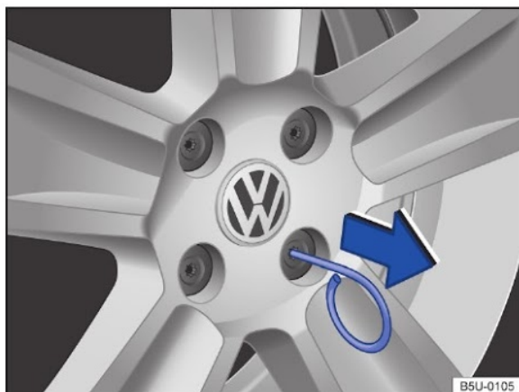
Fig. 141 Retirar as capas de cobertura dos parafusos da roda.
