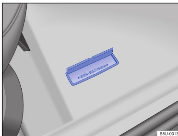
Fig. 151 Em frente ao banco do passageiro dianteiro: número de identificação do veículo (número do chassi) no assoalho, em frente ao banco do passageiro dianteiro.
