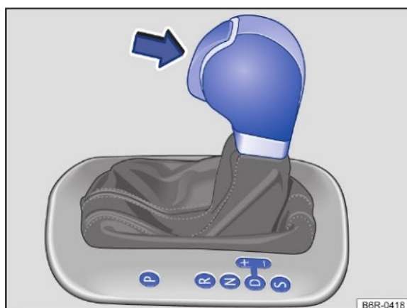
Fig. 84 Alavanca seletora da transmissão automática com botão bloqueador (seta).
