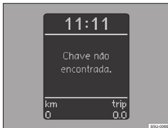
Fig. 82 No instrumento combinado: display com indicação do imobilizador ativado - veículos com Sistema de Informações Volkswagen.
