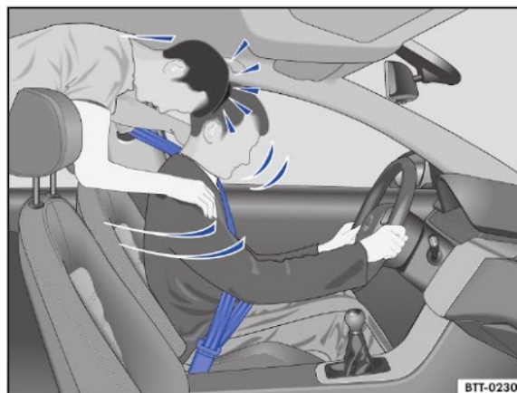
Fig. 27 O passageiro sem cinto de segurança no banco traseiro é lançado para frente sobre o condutor com cinto de segurança.
