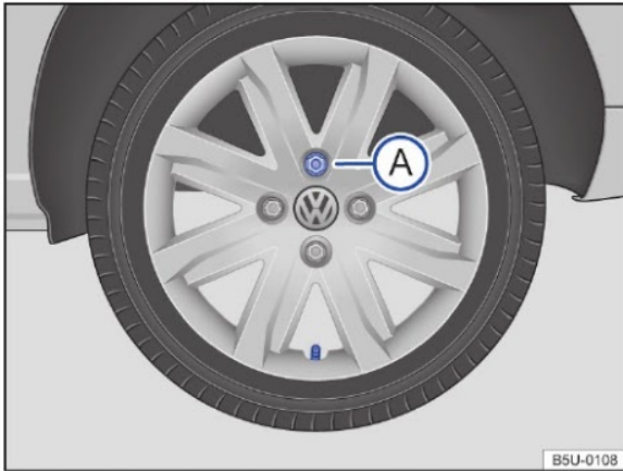
Fig. 145 Troca de roda: sequência de remoção dos parafusos da roda.
