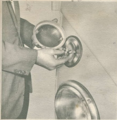
Substituição das lâmpadas dos indicadores de direção dianteiros
