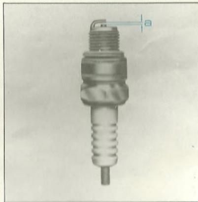
dos ( $a = 0,6 - 0,8$  mm) e, se necessário, torne a regulá-los, dobrando ligeiramente o eletrodo da "massa". Não se esqueça de recolocar os anéis de vedação das velas. A duração média das velas é, em geral, de 15.000 km.
