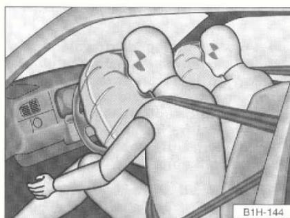
O saco de ar foi concebido de modo a permitir uma evacuação controlada do gás, sob a pressão exercida pelos ocupantes, amortecendo-lhes suavemente a cabeça e o peito. O saco de ar fica então suficientemente esvaziado para permitir a visibilidade em frente.
