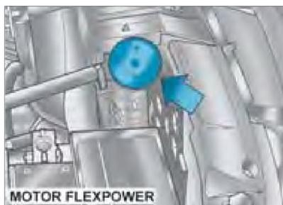
**Tampa de pressão do sistema de arrefecimento – motor Flexpower**
