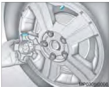
16. Instale a calota central; certifique-se de que a nervura na parte interna da calota fique voltada para o bico de enchimento do pneu.
