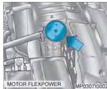
Se não for possível identificar o problema e o tanque de expansão do líquido de arrefecimento estiver vazio, poderá ser necessário abastecer o radiador. Desligue o motor e espere esfriar.
