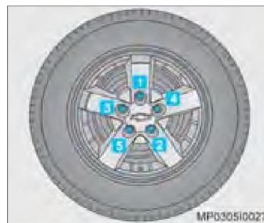
13. Reinstale os parafusos da roda, apertando-os parcialmente.
