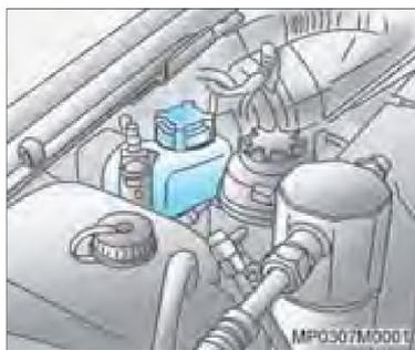
**Reservatório de gasolina para partida a frio (veículos com sistema Flexpower – álcool e gasolina)****Abastecimento**
