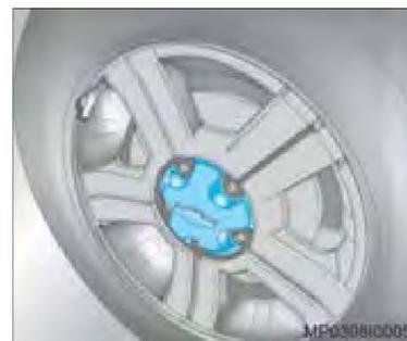
6. Remova a calota central, puxando-a com a mão. Afrouxe os parafusos de roda de meia volta a uma volta, mas não os remova.
