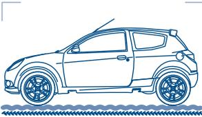
Evite passar sobre ruas alagadas para não molhar as polias e correias que acionam a bomba de direção. Caso isto aconteça, pode-se ouvir um ruído agudo no compartimento do motor, similar a um “chiado”, que não compromete o funcionamento do sistema de direção. Se o ruído persistir, procure um Distribuidor Ford.
