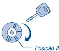
Se o motor não estiver em funcionamento, a chave da ignição deverá estar na posição II.
