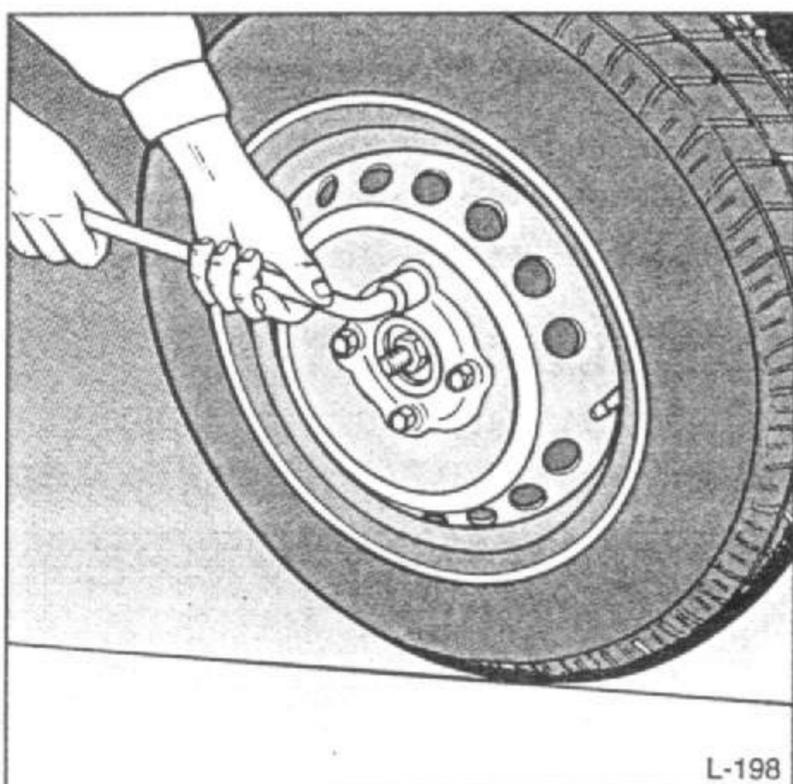
7. Remova as coberturas de cada parafuso e com a chave-de-roda, afrouxe os parafusos 1/2 a 1 volta; não os remova.
