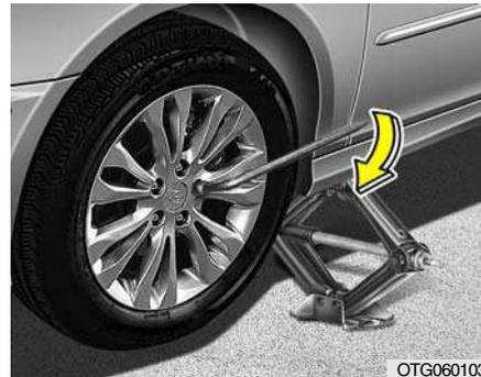
Em seguida, instale a chave como mostrado na figura e aperte as porcas da roda. Certifique-se de que o soquete esteja completamente encaixado sobre a porca. Não pise no cabo e não use um tubo de extensão no cabo da chave.
