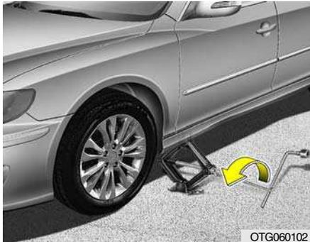
Abaixe completamente o veículo girando a chave de roda no sentido anti-horário.
