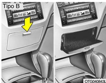
Para abrir, pressione a borda superior do porta-objetos (Tipo A) ou empurre o botão para baixo (Tipo B). Essa caixa é utilizada para guardar objetos pequenos.
