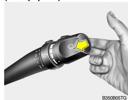
O lavador dos faróis é acionado em conjunto com a alavanca do lavador do pára-brisa. Para acionar o lavador dos faróis, puxe a alavanca do limpador/lavador no sentido do volante de direção cerca de aproximadamente 1 segundo. O lavador funciona quando o interruptor dos faróis está na segunda posição e a chave na posição ON (ligado).
