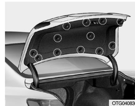
2. Com uma chave phillips, solte os parafusos de fixação e remova o acabamento da tampa do porta-malas.
