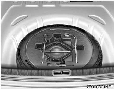
Retire a caixa de ferramentas e gire o parafuso de fixação no sentido anti-horário para retirar o pneu reserva do porta-malas.
