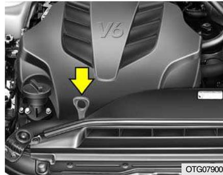
Antes de verificar o óleo, aqueça o motor à temperatura normal de operação e estacione o veículo em solo nivelado. Desligue o motor.
