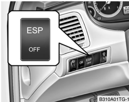
O sistema de Programa Eletrônico de Estabilidade (ESP) tem o objetivo de estabilizar o veículo durante manobras em curvas.
