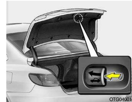
O seu veículo está equipado com uma alavanca de liberação de emergência da fechadura da tampa do porta-malas, localizada dentro do porta-malas. A alavanca é fluorescente para fácil localização no escuro.
