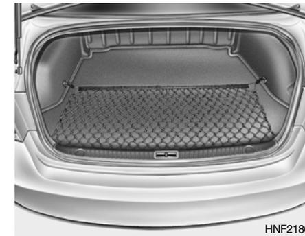
Ao transportar objetos no compartimento de bagagens, utilize os olhais localizados no assoalho para fixar a rede de proteção conforme mostrado na ilustração. A rede tem a finalidade de impedir a movimentação de objetos.
