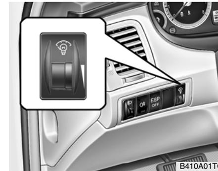
Para aumentar ou diminuir a luminosidade das luzes do painel de instrumentos gire o botão de controle das luzes do painel de instrumentos.
