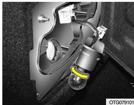
3. Para substituir a luz indicadora de direção, remova-a da base e instale a lâmpada nova.
