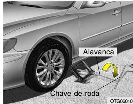
Após inserir a alavanca na chave de roda, instale a alavanca no macaco como mostrado na figura. Para levantar o veículo, gire a chave de roda no sentido horário. À medida que o macaco começa a levantar o veículo, verifique novamente que o mesmo está firmemente posicionado e não irá escorregar. Se o macaco estiver sobre solo macio ou areia, coloque uma prancha, tijolo, pedra chata ou outro objeto como apoio para impedir que o mesmo afunde.
