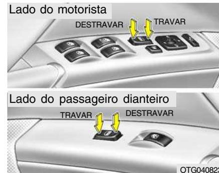
O interruptor de travamento central das portas está localizado no descanso-braço das portas dianteiras. Para operar o sistema, pressione o interruptor de travamento da porta. Se alguma porta estiver aberta após o travamento das portas a mesma permanecerá travada após o fechamento.
