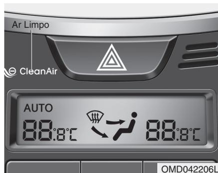
Quando o botão de ignição estiver na posição ON, a função Ar Limpo liga-se automaticamente. Do mesmo modo, a função Ar Limpo também se desliga automaticamente quando o botão de ignição passar para a posição OFF.
