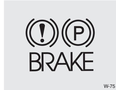
Verifique a luz de aviso do travão colocando o interruptor da ignição na posição ON (sem ligar o motor). Se o travão de estacionamento estiver engatado, esta luz acende-se com o interruptor da ignição na posição START ou ON.
