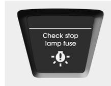
Quando o fusível da lâmpada de stop está desligado, acende-se no visor LCD o respectivo aviso durante 10 segundos. Substitua o fusível por um novo. Se isso não for possível, pode ligar o motor de arranque carregando durante 10 segundos no botão de ENGINE START/STOP em ACC.
