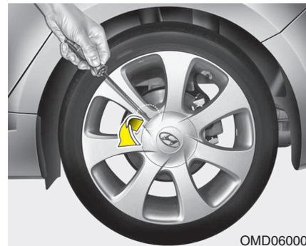
6. Insira a chave de parafusos na ranhura do tampão da roda e empurre delicadamente para retirar o tampão da roda (se instalado).
