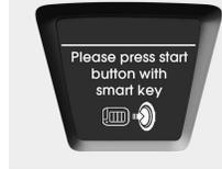
Se pressionar o botão de ENGINE START/STOP enquanto está iluminado o aviso "Chave não detectada", surge durante 10 segundos no visor LCD a mensagem "Por favor pressione o botão de arranque com o dispositivo smart key". Além disso, a luz indicadora do imobilizador de arranque pisca durante 10 segundos.
