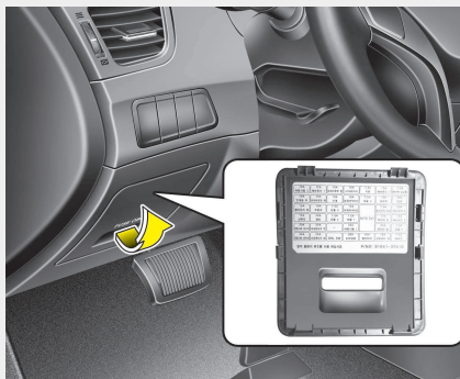
Painel de fusíveis interior
