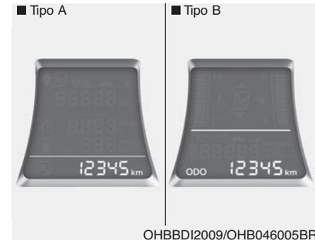
O hodômetro indica a distância total percorrida pelo veículo e deve ser utilizado para determinar quando a manutenção periódica deve ser realizada.
