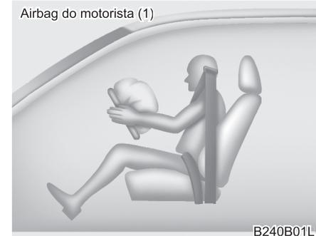
Os airbags estão localizados na parte central do volante e no painel frontal acima do porta-luvas. Quando o SRSCM detecta um impacto suficientemente severo na dianteira do veículo, ele aciona automaticamente os airbags.
