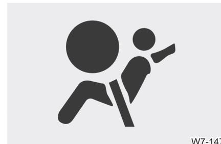
A finalidade da luz de advertência do airbag no painel de instrumentos é alertar o motorista sobre um possível problema com o sistema do airbag (SRS).
