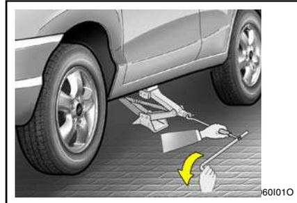
Baixar o veículo até ao solo rodando a chave para a esquerda. Posicione a chave como mostra na figura e aperte as porcas das rodas. Verifique se a chave está perfeitamente inserida na porca, para evitar que resvale. Não force a chave com o pé, nem use um tubo como extensão da chave. Aperte todas as porcas das rodas. Recomenda-se um segundo aperto a todas as porcas. Depois de uma mudança de roda, é aconselhável a revisão e o aperto por um técnico, logo que possível.
