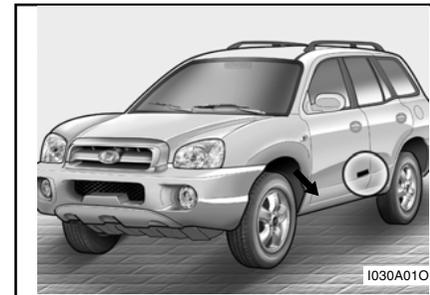
A etiqueta localizada no pilar central da porta do lado do condutor indica a pressão recomendada para os pneus do seu veículo.
