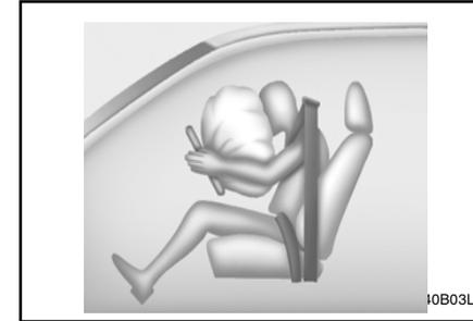
Após o accionamento, os recortes moldados directamente nas coberturas dos air bag separam-se devido à pressão de expansão dos air bag. Estas coberturas abrem-se totalmente, permitindo assim o enchimento total dos air bag.
