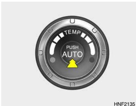
O sistema FATC (Controlo Temperatura Completamente Automático), controla automaticamente o aquecimento e arrefecimento, do seguinte modo:
