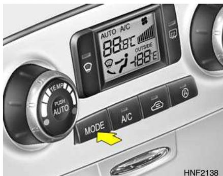
Este controle é usado para direccionar a saída de ar. O ar pode ser dirigido ao chão, saídas do painel de instrumentos ou pára-brisas. São usados quatro simbolos para representar estes comandos.
