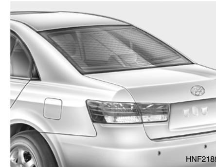
Quando o interruptor do rádio é ligado quando a chave de ignição está na posição "ON" ou "ACC", a sua viatura recebe ambos os sinais de difusão AM e FM através da antena existente no vidro traseiro.
