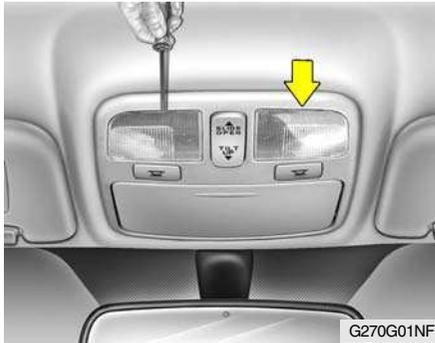
1. Retire a tampa plástica com uma chave de fendas.
