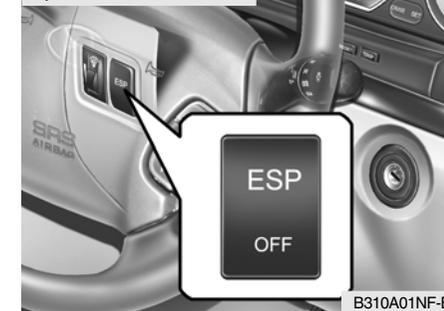
O sistema do Programa Electrónico de Estabilidade (ESP) foi concebido para estabilizar o veículo nas curvas.
