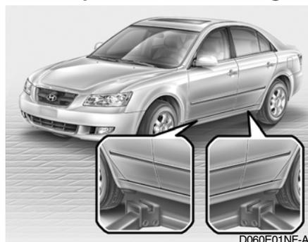
A base do macaco deve apoiar-se num lugar firme e nivelado. Instale-o como mostra a figura.
