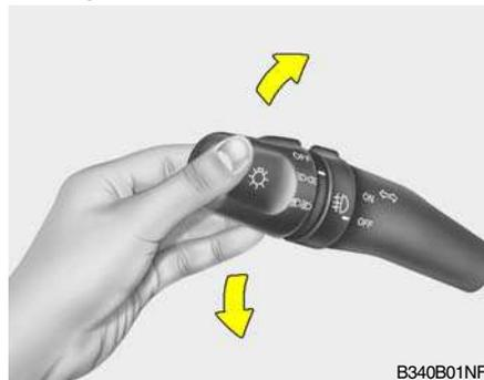
Para indicar uma mudança de faixa de rodagem, mova a alavanca para baixo ou para cima, conforme o desejar, até ao ponto em que os piscas comecem a funcionar. A alavanca voltará automaticamente à posição central quando solta.
