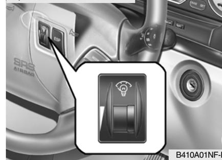
A intensidade da luz do painel de instrumentos pode ser regulada, rodando o botão de controlo da luz do painel de instrumentos.
