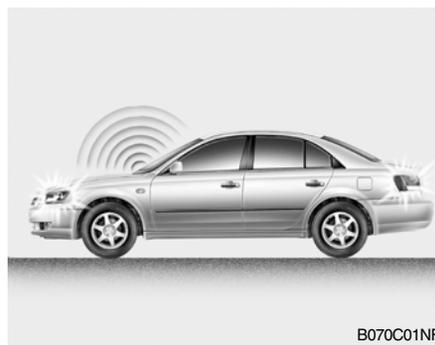
O alarme será accionado se ocorrer uma das seguintes condições enquanto a viatura está estacionada e o sistema tiver sido activado.
