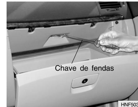
2. Retire a tampa da luz de iluminação do porta-luvas com uma chave de fendas.
