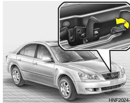
2. Prima a alavanca do trinco de segurança localizada do lado esquerdo e levante o capot.
