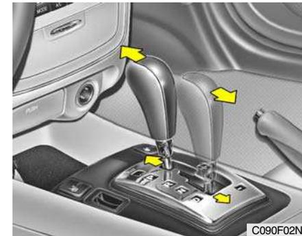
Quer a viatura esteja parada ou em movimento, o modo desportivo é seleccionado empurrando a alavanca selectora da posição "D" para a zona manual. Para voltar à posição "D", empurrar a alavanca selectora de novo para a zona principal.
