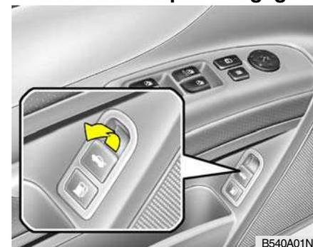
Para abrir a tampa da bagageira sem utilizar a chave, puxe para cima a alavanca de abertura. Para fechar, baixe a tampa e pressione até travar. Para ter a certeza que a tampa está devidamente fechada, tentar abri-la de novo.
