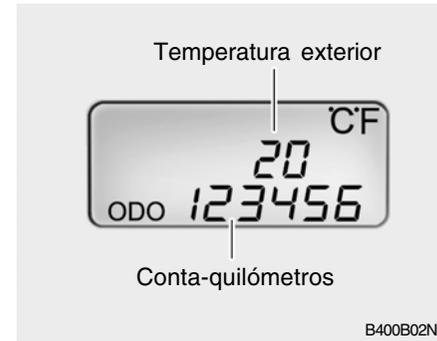
Este modo indica a temperatura exterior entre -40°C (-40°F) e 80°C (176°F).
