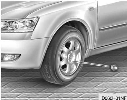
Para reinstalar as porcas encaixe-as nos pernes e aperte-as com os dedos. A ponta com menor diâmetro deve estar virada para dentro. Faça oscilar levemente o pneu para se certificar que está totalmente encaixado e volte a apertar com os dedos.
