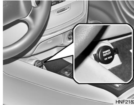
Fornecem corrente de 12 V e permitem ligar acessórios ou equipamento eléctrico, mas apenas quando a chave se encontra na posição "ON" ou "ACC".
