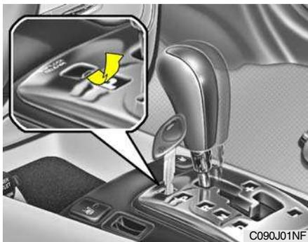
Se não conseguir mover a alavanca selectora da posição "P" (Park - Estacionamento) para qualquer outra posição ao mesmo tempo que pressiona a fundo o pedal do travão e com a chave de ignição na posição "ON", remova a tampa da consola e com um objecto fino, como por exemplo uma chave de fendas, empurre para baixo o botão de liberação da alavanca selectora. Em seguida, e ao mesmo tempo que pressiona o pedal do travão,
