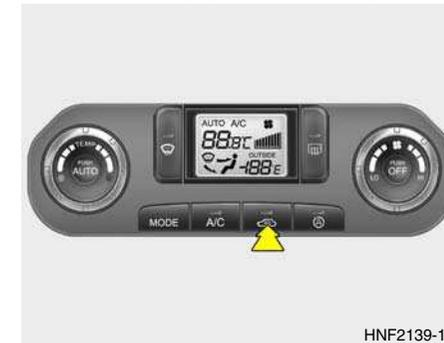
Este interruptor é utilizado para seleccionar ar fresco do exterior ou recircular o ar do habitáculo e evitar a entrada de gases de escape automaticamente.
