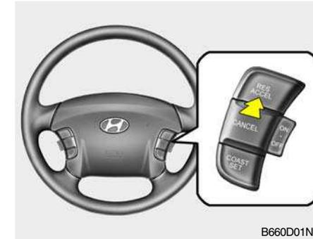
O veículo retoma automaticamente a velocidade seleccionada antes do cancelamento quando puxa o interruptor de comando "RESUME (ACCEL)" (acima dos 40 km/h).
