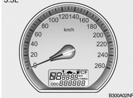
O velocímetro indica a velocidade do veículo em quilómetros ou milhas por hora.
