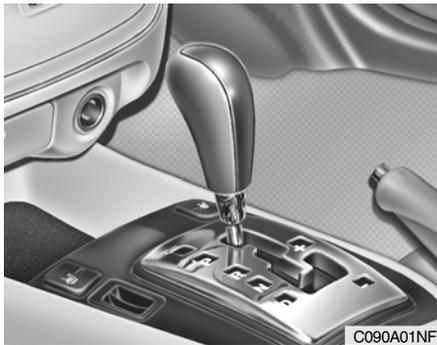
A transmissão automática da Hyundai de elevada eficácia tem quatro/cinco velocidades para a frente e uma velocidade de marcha-atrás. Cada uma das relações de caixa é seleccionada automaticamente, consoante a posição da alavanca selectora da caixa de velocidades. A alavanca selectora pode ser operada no modo principal (caixa automática) ou modo manual.
