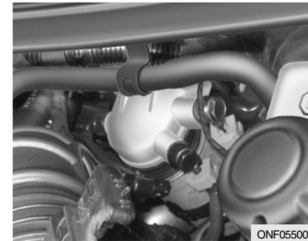
Se a lâmpada avisadora do filtro de combustível se acender durante a condução, indica que a água se acumulou no filtro de combustível. Se isto ocorrer, remover a água como a seguir se descreve.
