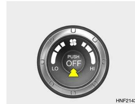
Pressione o botão "OFF" para desligar o sistema de aquecimento e refrigeração.
