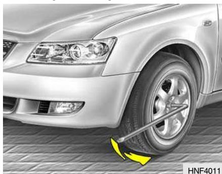
As porcas das rodas devem desapertar-se levemente antes de se levantar o automóvel. Solte as porcas, rodando o cabo da chave no sentido contrário ao dos ponteiros do relógio. Ao proceder desta maneira, assegure-se que a chave está perfeitamente inserida na porca, de forma a não resvalar. Para uma máxima eficiência coloque a chave para cima, como mostra a figura. Então, segure a chave o mais possível próximo do extremo, e puxe-a para baixo com firmeza. Rode a porca cerca de uma volta e meia.
