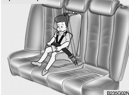
Utilize o cinto de segurança central do banco traseiro para fixar o sistema de retenção para crianças como se ilustra. Após a instalação do sistema de retenção para crianças, abanar o banco da criança para a frente e para trás, e de um lado para o outro para verificar se está correctamente fixo pelo cinto de segurança.
