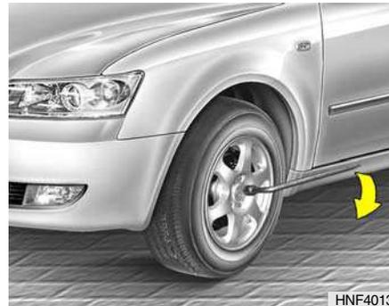
Posicione a chave como mostra na figura e aperte as porcas das rodas. Verifique se a chave está perfeitamente inserida na porca, para evitar que resvale. Não force a chave com o pé, nem use um tubo como extensão da chave. Aperte todas as porcas das rodas. Recomenda-se um segundo aperto a todas as porcas. Depois de uma mudança de roda, é aconselhável a revisão e o aperto por um técnico, logo que possível.
