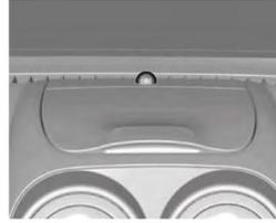
O sensor de iluminação localiza-se na parte superior do painel de instrumentos e acende/apaga o farol baixo quando o controle das luzes externas está no modo AUTO.
