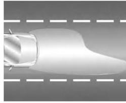
O farol baixo é projetado de forma a iluminar determinadas áreas com mais intensidade, fornecendo uma visualização da sinalização e reduzindo o efeito de ofuscamento para os motoristas que vêm na pista oposta. Essas regiões e intensidade de luz são normalizadas (as resoluções CONTRAN 227/07 e 294/08) e os faróis do seu veículo foram projetados para atender às regras de segurança e fornecer melhor desempenho de iluminação do veículo. Desta maneira, diferenças visuais ocasionais
