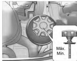
**Inspeção e completção do nível**
