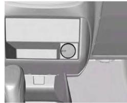
Existe apenas uma tomada de 12 V no painel central que permite a conexão de aparelhos elétricos, como telefones celulares e outros acessórios. O fornecimento de energia máximo para os acessórios não deve exceder a 120 watts para tomada de energia.
