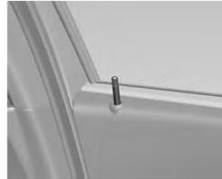
Para veículos sem o sistema central de travamento, as portas podem ser travadas individualmente pelo "pino" estando a porta aberta ou fechada, exceto a porta do motorista, que só pode ser travada com o pino se a mesma estiver fechada, para impedir que se esqueça a chave dentro do veículo.
