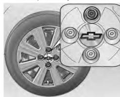
16. Instale os parafusos e aperte-os parcialmente.
