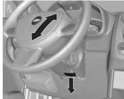
Destrave a alavanca, ajuste a altura do volante e trave-a novamente, e assegure-se de que está totalmente travada. Regule o volante apenas quando o veículo estiver parado e a coluna de direção destravada.
