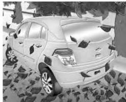
Evite estacionar ou manter o veículo sobre capim seco, arbustos, respingos de combustível e outros materiais inflamáveis quando o sistema de descarga estiver aquecido. Dependendo da situação, isto pode causar um princípio de incêndio.
