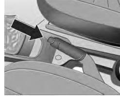
Para soltar o freio de estacionamento, puxe a alavanca levemente para cima, aperte o botão na sua extremidade (seta) e empurre-a para baixo até a lâmpada indicadora (L) do painel apagar.
