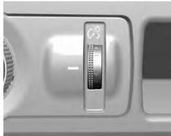
Este recurso controla a intensidade das luzes do painel de instrumentos. O botão localiza-se próximo do controle de iluminação externa. Gire o botão para cima ou para baixo para aumentar ou diminuir as luzes do painel de instrumentos.
