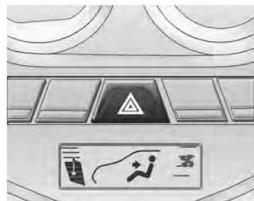
Pressione este botão localizado no painel de instrumentos próximo do sistema de controle de ventilação e ar condicionado, para fazer com que as luzes indicadoras dos sinalizadores de direção dianteiros e traseiros pisquem. Isto avisa os outros que você tem uma emergência e só deve ser utilizado com o carro parado. Pressione novamente para desligar o pisca-alerta.
