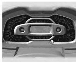
No painel de instrumentos podem ser visualizados: velocímetro, tacômetro, indicador de nível de combustível, luz de advertência da temperatura do líquido de arrefecimento do motor, sinalizadores de direção e respectivas luzes indicadoras.
