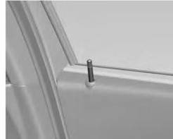
Pressione os pinos de travamento para operar as travas das portas de dentro do veículo. Se, inadvertidamente, as travas da porta do motorista travarem ao fechar, a alavanca retornará para a posição de destravamento. Isto evitará que o veículo seja travado com a chave dentro.
