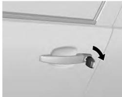
Gire a chave no sentido horário. Será acionado o travamento das portas e da tampa de acesso ao bocal de abastecimento do tanque de combustível. O alarme não é ativado com o travamento do carro com a chave.
