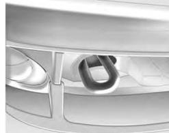
O gancho de reboque só pode ser usado para esta função, não para desatolar o veículo.
