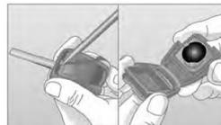
Se o raio de ação do controle remoto ficar reduzido, substitua a bateria.
