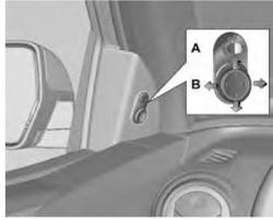
Interruptor de quatro posições na porta do motorista. Selecione o espelho correspondente com o interruptor "A" e ajuste com o interruptor "B".
