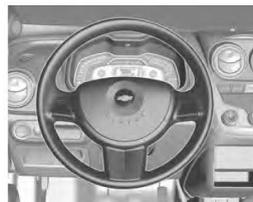
Para veículos equipados com airbag, pressionar qualquer ponto com o símbolo . Para veículos sem airbag, pressionar qualquer ponto do centro do volante.
