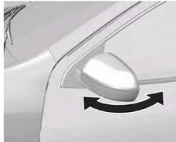
Os espelhos retrovisores externos podem se movimentar na direção mostrada na figura; este recurso foi projetado para a proteção de pedestres no caso de colisão. Os espelhos também podem ser movimentados manualmente para reduzir a largura total do veículo e também para evitar danos quando o veículo estiver estacionado.
