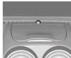
Ao acionar o sistema de alarme antifurto, a luz permanece acesa por 10 segundos e começa a piscar indicando a ativação do sistema.
