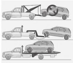
Em situações de emergência que exijam o reboque do veículo, procure, de preferência, empresas especializadas com carros-guincho ou a assistência oficial da rodovia, usando veículos de reboque que tenham apoio para as rodas ou plataforma para receber o automóvel.
