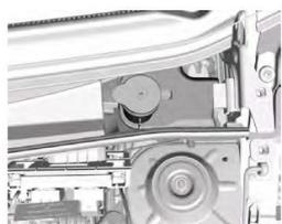
O reservatório de líquido do sistema de lavagem do para-brisa fica situado na lateral esquerda do compartimento do motor. O volume do reservatório é de aproximadamente 2,6 litros. Para uma limpeza eficiente, recomenda-se acrescentar à água um aditivo de limpeza.
