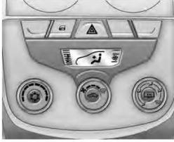
Gire o botão de direcionamento do fluxo de ar para a posição . Resfriamento ligado. Ajuste o controle de temperatura para o nível mais quente. Ajuste a velocidade do ventilador para a posição . Desembaçador do vidro traseiro ligado.
