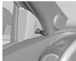
Os espelhos externos são ajustáveis com facilidade através das alavancas de ajuste dentro do veículo. Para efetuar o ajuste de posição, mova a alavanca de ajuste instalada no painel da porta.
