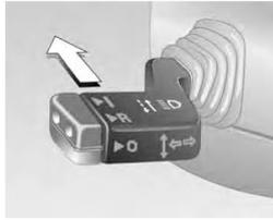
Com botão dos faróis na posição **H**, o farol alto é obtido empurrando-se a alavanca para a frente. Par voltar para a condição de farol baixo, a alavanca deve ser empurrada para a frente novamente.
