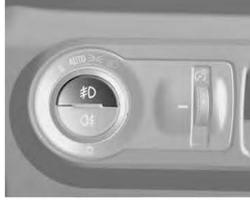
Para veículos equipados com faróis de neblina, o botão encontra-se no controle de iluminação externa do lado externo do painel de instrumentos.
