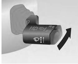
Funciona somente com a ignição ligada. O limpador e o lavador do vidro traseiro funcionam em ambas as posições da alavanca.
