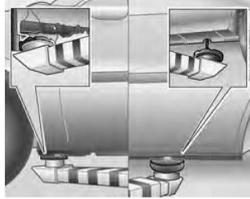
O local dos pontos de apoio de um elevador ou macaco tem de ser aplicado somente nos locais indicados nas figuras, nas porções dianteira e traseira, nas áreas entre o recesso para instalação do macaco e as caixas das rodas.
