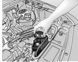
O sistema de arrefecimento do motor é abastecido com um aditivo para radiador de longa duração (etilenoglicol), cujas propriedades conferem proteção adequada contra congelamento, ebulição e corrosão. O líquido de arrefecimento deve ser trocado a cada cinco anos ou 150.000 km.
