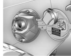
Reabasteça antes que o indicador de nível baixo de combustível no painel de instrumentos acenda ou que o indicador de combustível alcance a indicação de limite inferior. Para evitar danos ao recipiente, que recupera os gases que saem do tanque de combustível e, conseqüentemente, reduz a contaminação do ambiente, reabasteça o tanque de combustível lentamente e, depois da terceira desconexão automática do enchimento da bomba, interrompa o reabastecimento.
