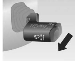
Para esguichar água para a lavagem do para-brisa, puxe a alavanca. Os limpadores serão acionados logo após o acionamento da alavanca e o esguicho da água no para-brisa.
