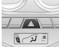
Pressione este botão localizado no painel de instrumentos próximo do sistema de controle de ventilação e ar condicionado, para fazer com que as luzes indicadoras dos sinalizadores de direção dianteiros e traseiros pisquem. Isto avisa os outros que você tem uma emergência e só deve
