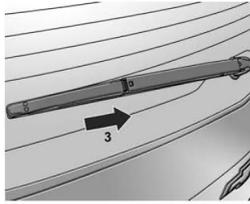
Para instalar uma lâmina nova, pressione-a (seta 3) até que a aba de travamento fique travada no orifício do braço.
