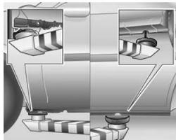
O local dos pontos de apoio de um elevador ou macaco tem de ser aplicado somente nos locais indicados nas figuras, nas porções dianteira e traseira, nas áreas entre o recesso para instalação do macaco e as caixas das rodas.
