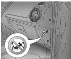
Veículos equipados com airbag podem ser identificados pela palavra "airbag" na etiqueta adesiva na lateral do painel de instrumentos, ela está visível quando a porta do passageiro está aberta.
