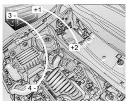
9. Conecte os cabos de extensão na sequência indicada:
