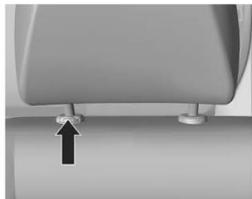
Para remover o apoio de cabeça, pressione o botão de destravamento (seta) e puxe o apoio de cabeça.
