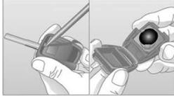
Se o raio de ação do controle remoto ficar reduzido, substitua a bateria.
