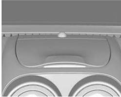
O sensor de iluminação se localiza na parte superior do painel de instrumentos e acende/apaga os faróis baixos quando o controle das luzes de lanterna está no modo AUTO.
