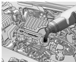
Seu veículo sai da fábrica com óleo de motor API-SL com viscosidade SAE 5W30.
