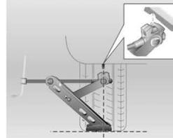
10. Ao levantar o macaco, verifique se a borda da sua base está encostando no chão e coloque-o diretamente embaixo do recesso da lâmina.
