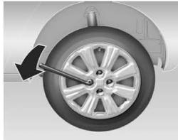
7. Com a chave de roda, afrouxe os parafusos, soltando 1/2 a 1 volta, sem retrá-los.
