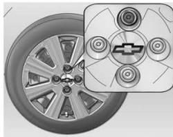
16. Instale os parafusos e aperte-os parcialmente.
