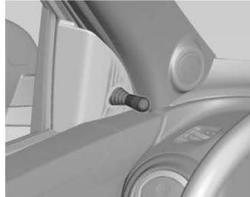
Os espelhos externos são ajustáveis com facilidade através das alavancas de ajuste dentro do veículo. Para efetuar o ajuste de posição, mova a alavanca de ajuste instalada no painel da porta.
