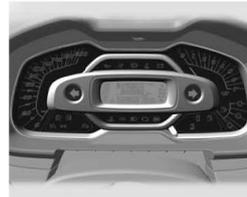
No painel de instrumentos podem ser visualizados: velocímetro, tacômetro, indicador de nível de combustível, luz de advertência da temperatura do líquido de arrefecimento do motor, sinalizadores de direção e respectivas luzes indicadoras.
