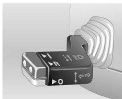
Com o controle de velocidade de cruzeiro, o veículo pode manter-se a 40 km/h ou mais sem você pisar no acelerador. O controle não funciona para velocidades abaixo de 40 km/h.
