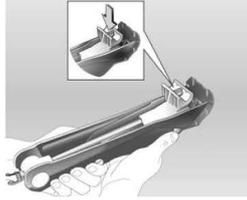
9. Posicione o braço do macaco no encaixe mais perto da roda que será trocada. A garra do macaco (seta) deve cobrir a lâmina vertical e encaixar no seu rebaixo.
