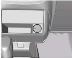
Existe apenas uma tomada de 12 V no painel central que permite a conexão de aparelhos elétricos, como carregadores de telefones celulares e outros acessórios. O fornecimento de energia máximo para os acessórios não deve exceder a 120 W para tomada de energia. Não conecte aparelhos que forneçam energia elétrica para o soquete como, por exemplo, baterias.
