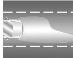
O farol baixo é projetado de forma a iluminar determinadas áreas com mais intensidade, fornecendo uma visualização da sinalização e reduzindo o efeito de ofuscamento para os motoristas que vêm na pista oposta. Essas regiões e intensidade de luz são normalizadas (as resoluções CONTRAN 227/07 e 294/08) e os faróis do seu veículo foram projetados para atender às regras de segurança e fornecer melhor desempenho de iluminação do veículo. Desta maneira,
