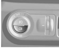
Para veículos equipados com as luzes de neblina traseiras, o botão encontra-se no controle de iluminação externa, do lado externo do painel de instrumentos.
