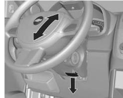
Destrave a alavanca, ajuste a altura do volante e trave-a novamente, e assegure-se de que está totalmente travada.
