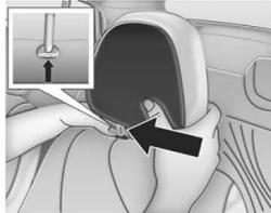
Para ajustar o apoio de cabeça pressione o botão de destravamento (seta) e deslize o apoio de cabeça ajustando-o com as mãos para cima ou para baixo. O apoio de cabeça pode ser posicionado em três alturas diferentes.
