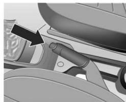
Para soltar o freio de estacionamento, puxe a alavanca ligeiramente para cima, aperte o botão na sua extremidade (seta) e empurre-a para baixo até a lâmpada indicadora (Ⓞ) do painel apagar.
