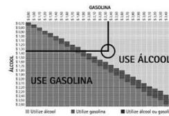
Se a linha cruzada correspondente a esses valores estiver na área cinza claro do gráfico, reabasteça com etanol; por outro lado, se a linha estiver localizada na área cinza escuro do gráfico, reabasteça com gasolina. A área colorida do gráfico mostra que não há qualquer diferença entre reabastecer com etanol ou com gasolina.
