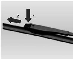
Pressione a aba de travamento (seta 1) e puxe a lâmina do limpador para removê-la (seta 2).
