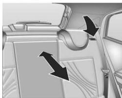
O encosto do banco traseiro pode ser travado em várias posições <sup>1)</sup>. Para ajustar, pressione o botão de desbloqueio e coloque o encosto na posição desejada.
