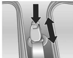
Para efetuar o ajuste, pressione o botão (seta esquerda) e ajuste a altura de acordo com sua estatura (seta direita). Isto é particularmente
