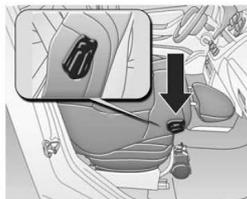
O encosto do banco dianteiro do passageiro pode ser rebatido até a posição horizontal do encosto puxando a alavanca localizada na parte superior externa do encosto.
