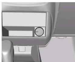
Há um soquete de 12 V no painel central que permite a conexão de aparelhos elétricos. O fornecimento de energia máximo para os acessórios não deve exceder a 120 W para tomada de energia.
