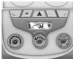
Além do fluxo de ar natural que entra no interior do veículo pelas entradas de ar no painel dianteiro, quando o veículo está em movimento, pode ser acionado também um ventilador para aumentar o fluxo de ar. Para maior conforto, este ar pode ser aquecido ou refrigerado (por meio do condicionador de ar).
