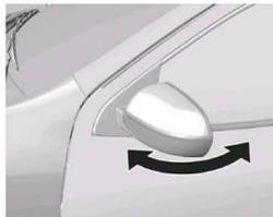
Os espelhos retrovisores externos podem se movimentar na direção mostrada na figura; este recurso foi projetado para a proteção de pedestres no caso de colisão. Os espelhos também podem ser movimentados manualmente para reduzir a largura total do veículo e também para evitar danos quando o veículo estiver estacionado.
