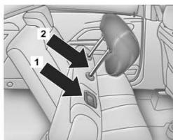
Para remover o apoio de cabeça, pressione o botão do encosto traseiro (1), recline-o um pouco para frente, pressione o botão de destravamento (2) e puxe o apoio de cabeça para cima.
