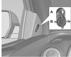
Interruptor de quatro posições na porta do motorista. Selecione o espelho correspondente com o interruptor "A" e ajuste com o interruptor "B".
