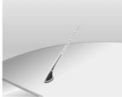
A antena do rádio localiza-se na parte dianteira do teto. Para remover, gire no sentido anti-horário. Para instalar a antena gire no sentido horário.
