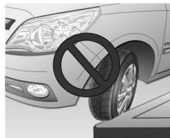
Os impactos contra as guias da calçada podem causar lesões nas rodas e pneus por dentro. Há risco de acidentes a alta velocidade devido a danos externos ocultos nos pneus.
