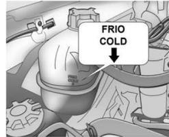
Raramente ocorrem perdas em um sistema de arrefecimento em circuito fechado. Por isto, raramente é preciso completar o nível, que no entanto deve ser conferido semanalmente, com o veículo sobre uma superfície plana e o motor frio.
