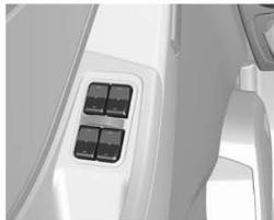
Uma leve pressão no interruptor de atuação permite a abertura ou o fechamento dos vidros em pequenas etapas. Mantenha o interruptor pressionado durante um intervalo maior para a abertura ou o fechamento automático; para parar o movimento do vidro, pressione novamente o interruptor.
