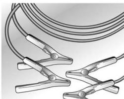
Para dar partida em um veículo com a bateria descarregada, ligue os cabos de extensão na bateria de outro veículo. Isto deve ser feito com extremo cuidado e cumprindo as instruções a seguir.
