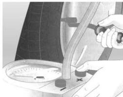
O excesso de pressão resultante do aquecimento dos pneus depois de uma viagem é normal e não deve ser reduzido.
