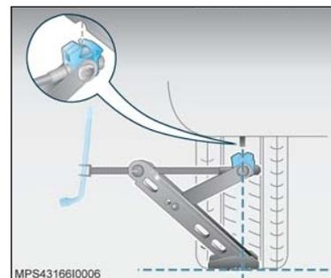
10. Posicione o braço do macaco no encaixe mais próximo da roda a ser substituída, de modo que a garra do macaco envolva a lâmina vertical e encaixe no rebaixo da lâmina.
