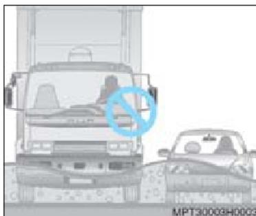
Se realmente for preciso atravessar um trecho alagado, fazê-lo sempre em baixa velocidade, em torno de 10 km/h, utilizando a 1ª marcha ou 1, se a transmissão for automática. É preciso ficar atento aos veículos de grande porte trafegando nas proximidades, pois podem ser produzidas marolas de grandes proporções, aumentando as probabilidades de danos.
