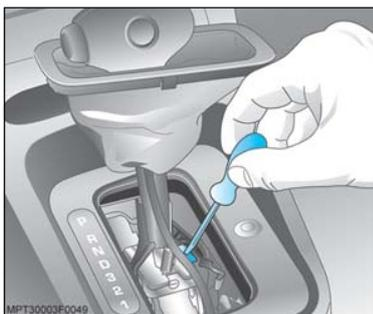
4. Empurre a garra amarela para frente com o auxílio de uma chave de fenda e aperte o botão lateral da manopla da alavanca seletora para uma posição diferente de **P**.
