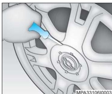
6. (Roda com calota central). Remova a calota central com o auxílio de uma chave de fenda.
