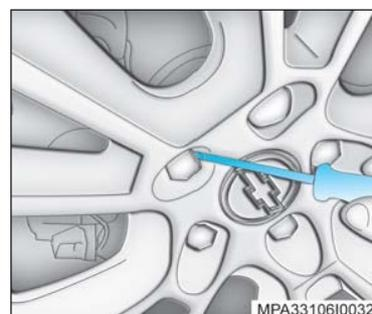
7. (Roda sem calota central). Remova as coberturas dos parafusos.
