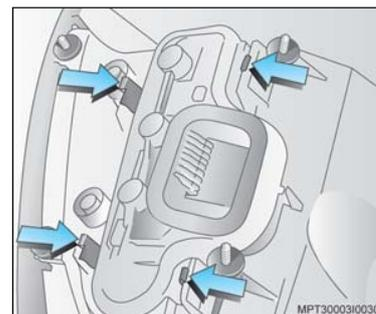
5. Pressione simultaneamente as linguetas de retenção localizadas na parte externa do soquete e remova o soquete da lâmpada. Sequência de lâmpadas (de cima para baixo):
