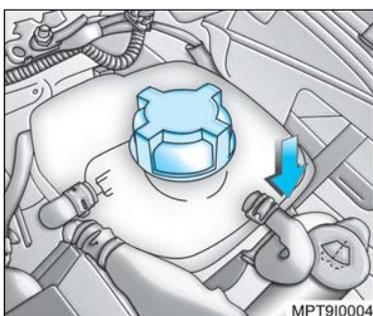
**Sistema de arrefecimento****Troca do líquido de arrefecimento**
