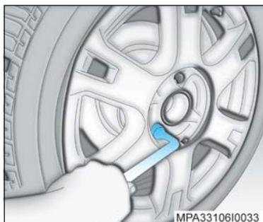
8. Com a chave de roda, afrouxe os parafusos meia a uma volta, não os remova.
