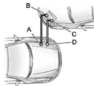
5. Conecte uma extremidade do cabo positivo (+) vermelho ao terminal (A) positivo (+) de partida auxiliar. A conexão positiva de partida auxiliar é coberta por uma tampa vermelha. Remova-a para expor o terminal.
