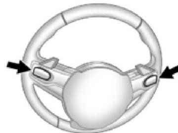
A mudança por toque permite ao motorista controlar manualmente a transmissão automática. Para usar a mudança por toque, a alavanca de mudança deverá estar posicionada em M (Modo Manual). Os veículos com este dispositivo trazem identificadores no volante de direção. Os controles estão localizados na parte traseira do volante de direção.
