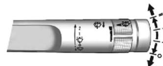
A alavanca do limpador/lavador do para-brisa está localizada no lado direito da coluna de direção.
