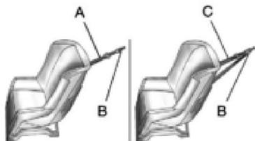
Uma cinta superior (A, C) faz ancoragem da extremidade superior do sistema de proteção para crianças no veículo. Uma ancoragem para a cinta superior é construída no veículo. O elemento de fixação da cinta superior (B) no sistema de proteção para crianças é conectado à ancoragem da cinta superior no veículo para reduzir o movimento para frente e a rotação do sistema de proteção para crianças durante a condução ou em caso de colisão.
