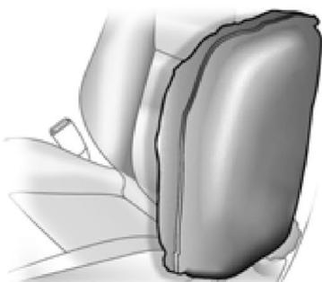
O seu veículo é equipado com airbag para impacto lateral montado nos bancos. Os airbags laterais montados no banco e airbags de cortina foram projetados para inflar nas colisões laterais moderadas a severas. Além disso, estes airbags de cortina foram projetados para inflar em um impacto frontal severo. Os airbags laterais montados no banco e airbags de cortina irão inflar se a severidade de uma colisão estiver acima do nível do limite projetado para o sistema.
