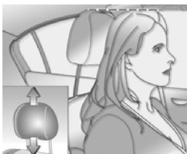
Os bancos dianteiros do veículo são equipados com apoios de cabeça ajustáveis nas posições externas dos bancos.
