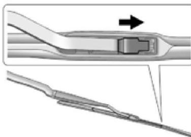
2. Levante a trava no meio da palheta do limpador na posição de fixação do braço do limpador.
