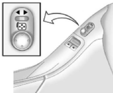
Nos veículos equipados com espelhos externos elétricos, existem controles localizados no descanso-braço da porta do motorista.
