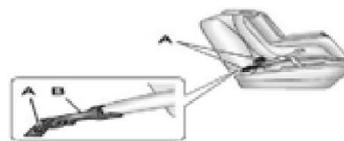
As ancoragens inferiores (A) consistem de barras metálicas construídas no veículo. Existem duas ancoragens inferiores para cada posição de assento LATCH que irão acomodar o sistema de proteção para crianças com elementos de fixação inferiores (B).
