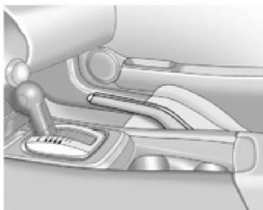
Para aplicar o freio de estacionamento, levante a alavanca do freio de estacionamento. Não é necessário pressionar o botão de liberação enquanto o freio de estacionamento estiver sendo aplicado. Se a ignição estiver posicionada em Ligado/Funcionando, a luz de advertência do sistema de freio irá acender.
