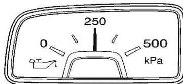
O medidor de pressão de óleo do motor está localizado na frente do seletor de mudança, e indica a pressão de óleo em kPa (kilopascals) quando o motor está funcionando.
