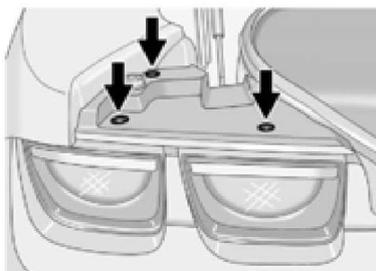
2. Remova os retentores do painel de fechamento para permitir o acesso aos conectores do soquete da lâmpada.
