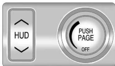
O controle do HUD está localizado no lado direito do volante de direção. Para ajustar a imagem do HUD de modo que os itens sejam apresentados apropriadamente, proceda conforme segue:
