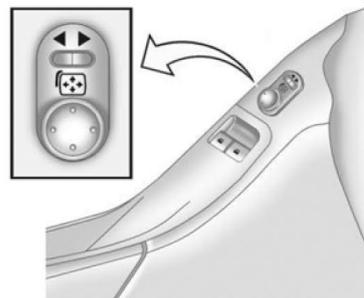
Os veículos equipados com espelhos externos elétricos possuem controles localizados no descanso-braço da porta do motorista.
