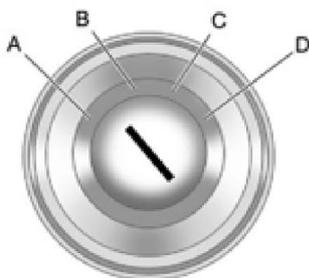
O interruptor de ignição tem quatro posições diferentes.
