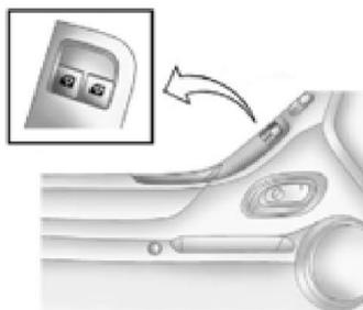
Os interruptores do vidro elétrico localizados na porta do motorista controlam todos os vidros. O interruptor do vidro elétrico na porta do passageiro controla somente aquele vidro. Pressione para baixo a parte dianteira do interruptor para abrir o vidro. Puxe o interruptor para cima para fechar o vidro.
