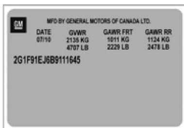
A etiqueta de certificação específica do veículo está fixada na coluna central do veículo (coluna B), lado do motorista acima do mecanismo de travamento. A etiqueta indica a capacidade de peso bruto do veículo, designada, classificação de peso bruto do veículo (GVWR).
