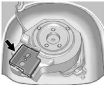
Este veículo está equipado com um kit de vedante para pneu e compressor em substituição ao macaco ou pneu de reserva. Ele está localizado dentro do porta-malas.
