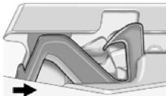
2. Acione a alavanca de destravamento secundário do capô do motor. A alavanca está localizada à esquerda do centro do capô do motor.
