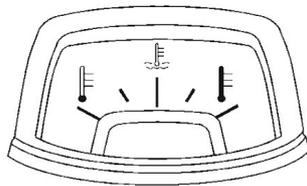
Este medidor está localizado na frente do seletor de mudança, e indica a temperatura do líquido de arrefecimento do motor.
