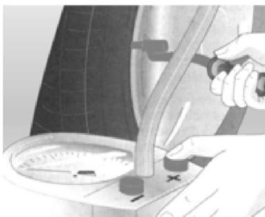
O excesso de pressão resultante do aquecimento dos pneus depois de uma viagem é normal e não deve ser reduzido.
