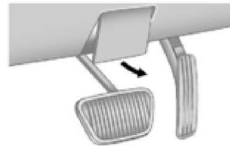
1. Puxe a alavanca de destravamento que está localizada abaixo do painel de instrumentos à esquerda do volante de direção.
