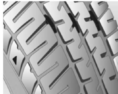
Por razões de segurança, os pneus devem ser substituídos quando a profundidade dos sulcos da banda de rodagem se aproximar de 3 mm.
