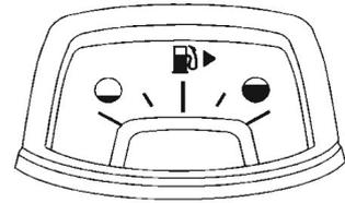
Quando a ignição está ligada, o indicador de combustível indica a quantidade de combustível restante no tanque de combustível do veículo.
