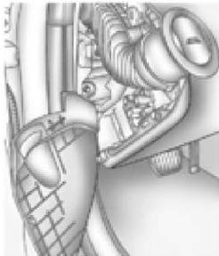
O bloco de fusíveis no painel de instrumentos está localizado na extremidade do painel de instrumentos, no lado do motorista. Para permitir o acesso aos fusíveis, abra a cobertura do painel de fusíveis puxando para fora pela parte inferior.
