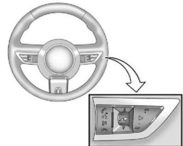
Nos veículos equipados com controles de áudio no volante de direção, alguns controles de áudio podem ser ajustados no volante de direção.
