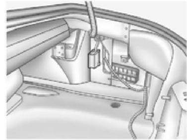
O bloco de fusíveis do compartimento traseiro está localizado no lado direito do porta-malas atrás de sua tampa. Remova os seis retentores para rede de proteção, a soleira traseira e os dois retentores do painel de acabamento lateral no lado do passageiro, a seguir mova para deslocar totalmente o painel de acabamento.
