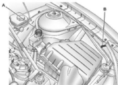
Os terminais positivo (A) e negativo (B) para partida com bateria auxiliar estão localizados no compartimento do motor, lado do motorista. Estes terminais são utilizados ao invés de uma conexão direta com a bateria. A conexão positiva de partida auxiliar é coberta por uma tampa vermelha. Remova-a para expor o terminal.
