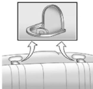
As ancoragens da cinta superior estão localizadas no painel de enchimento do encosto do banco traseiro. Certifique-se de usar uma ancoragem localizada no lado do veículo em cuja posição de assento o sistema de proteção para crianças será instalado.
