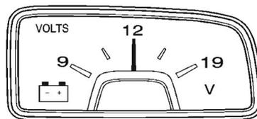
Este medidor está localizado na frente do seletor de mudança, e indica o estado de carga da bateria em voltagem de corrente contínua. Quando o motor estiver funcionando, e a ignição estiver ligada, este medidor irá indicar a condição do sistema de carga.
