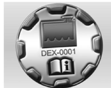
3. Gire a tampa da vareta medidora do líquido de arrefecimento do motor no sentido anti-horário e lentamente remova a vareta medidora.
