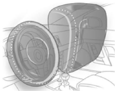
Os airbags frontais foram projetados para inflar nas colisões frontais ou quase frontais moderadas a severas ou para ajudar a reduzir o potencial de ferimentos graves especialmente à cabeça e tórax do motorista ou passageiro da frente, lado direito.
