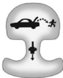
Existe uma alavanca de destravamento de emergência do porta-malas localizada no interior do porta-malas na fechadura do porta-malas. Em alguns veículos, a alavanca de destravamento pode ser acessada dobrando-se o encosto do banco traseiro. Consulte Bancos traseiros.
