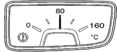
Este medidor está localizado na frente do seletor de mudança e indica a temperatura do óleo da transmissão quando a ignição está ligada.
