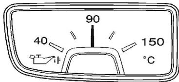
O medidor está localizado na frente do seletor de mudança, e indica a temperatura do óleo do motor.
