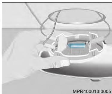
2. Remova a lâmpada do alojamento, puxando-a pelo bulbo e coloque uma nova lâmpada.
