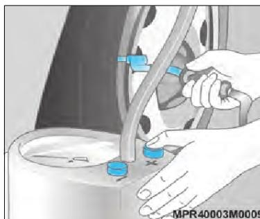
Após a verificação da pressão dos pneus, coloque novamente as tampas de proteção das válvulas dos bicos de enchimento.
