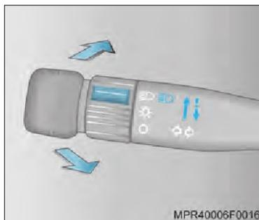
**Farol alto:** acende-se movendo-se a alavanca do sinalizador de direção para frente. A luz indicadora de farol alto permanece acesa no painel de instrumentos.
