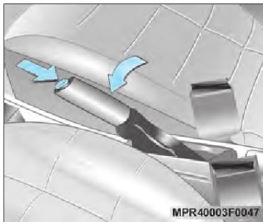
Para liberação do freio de estacionamento, force ligeiramente a alavanca para cima, comprima o botão na extremidade da alavanca (seta) e empurre-a para baixo até que a luz indicadora do painel se apague.
