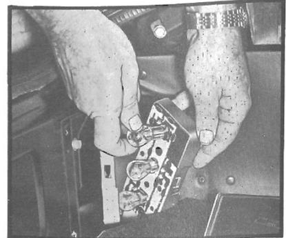
3. Retire a lâmpada empurrando-a, girando-a no sentido anti-horário e puxando-a.
