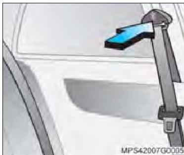
**Ajuste da altura do cinto de três pontos dianteiro**
