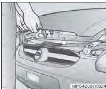
Para abrir completamente, levante a trava do trinco de segurança, localizada ligeiramente à esquerda, a partir do centro, quando vista pela parte dianteira do veículo.
