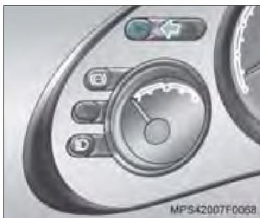
Quando a ignição for ligada, o indicador de controle para o sistema de injeção eletrônica
