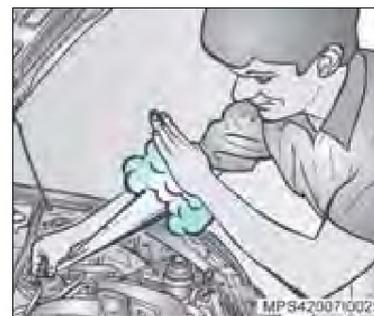
**Atenção!** Os vapores e líquidos escaldantes provenientes do sistema de líquido de arrefecimento em ebulição estão sob alta pressão e, se a tampa do reservatório for aberta, mesmo que parcialmente, os vapores poderão ser expelidos a alta velocidade, ou mesmo explodir, causando queimaduras graves. Nunca gire a tampa do reservatório enquanto o motor e o sistema de arrefecimento estiverem quentes. Se houver necessidade de girar a tampa, espere o motor esfriar.
