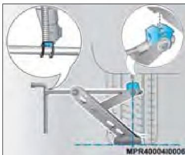
8. Posicione o braço do macaco no encaixe mais próximo da roda a ser substituída, de modo que a garra do macaco (seta) envolva a lâmina vertical na região do rebaixo da lâmina.
