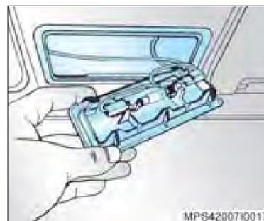
2. Remova a lâmpada do alojamento, puxando-a pelo bulbo e coloque uma nova lâmpada.
