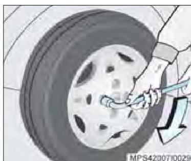
6. Com a chave de roda, afrouxe os parafusos de meia a uma volta; não os remova.
