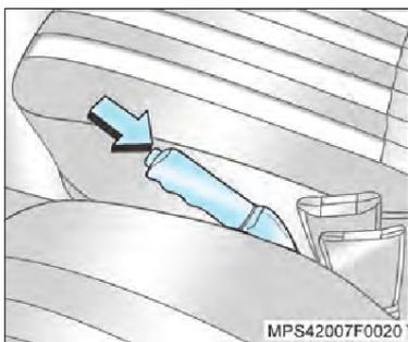
Para liberação do freio de estacionamento, force ligeiramente a alavanca para cima, comprima o botão na extremidade da alavanca (seta) e empurre-a para baixo até que a luz indicadora (D) do painel se apague.
