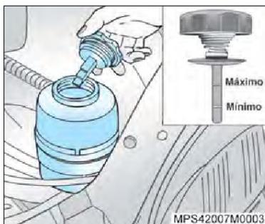
**Direção hidráulica****Inspeção e complementação do nível de fluido**
