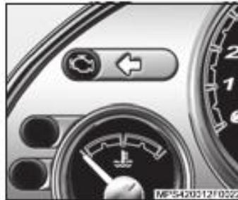
Cuando el encendido fuese conectado, el indicador de control del sistema de inyección electrónica se enciende brevemente. En caso de que quede destellando con el encendido conectado, hay algún defecto en el sistema. No podrá ser dado arranque al motor.
