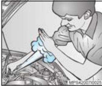
**▲ Peligro** Los vapores y líquidos hirvientes provenientes del sistema de líquido de enfriamiento en ebullición están bajo alta presión, y si la tapa del depósito fuese abierta aunque parcialmente, los vapores podrían ser expulsados en alta velocidad, o también explotar, llevando a quemaduras graves. Jamás gire la tapa del depósito mientras el motor y el sistema de enfriamiento estuviesen calientes. Si fuese necesario girar la tapa, espere hasta que el motor enfíe.
