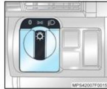
**Alumbrado de los instrumentos del tablero**
