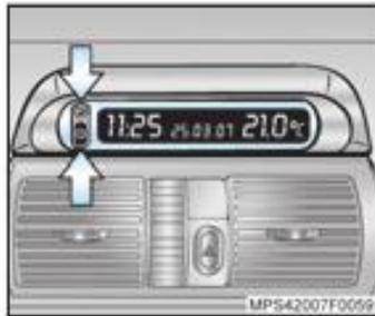
Con el encendido y el sistema de audio (de estar equipado) desconectados es posible consultar la hora, el calendario y la temperatura externa, por medio de un rápido accionamiento de una de las teclas ubicadas a la izquierda del módulo. La indicación se mantiene durante cerca de 15 segundos.
