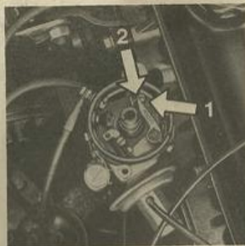
1. Parafuso de fixação e ajustagem 2. Calibragem dos platinados
