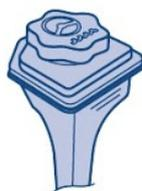
Reservatório do fluido da direção hidráulica
