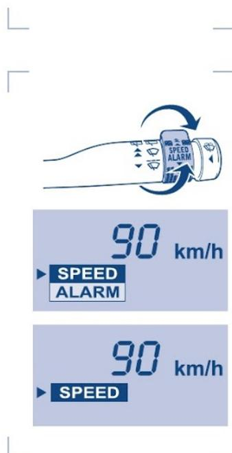
Para diminuir ou aumentar o valor do alarme de velocidade, gire o botão “**Speed Alarm**” para baixo e para cima, quando a tela de alarme de velocidade estiver ativa.
