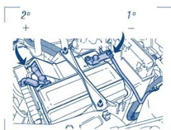
Após desligada a ignição, desconecte os cabos da bateria. Comece pelo cabo negativo (-).
