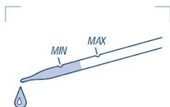
Retire a vareta do nível do óleo e limpe-a com um pano limpo que não solte pêlos. Coloque e retire novamente a vareta para verificar o nível do óleo.
