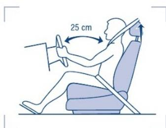
Use o cinto de segurança e mantenha uma distância mínima de 25 cm entre o volante e o peito do motorista para reduzir o perigo de ferimento por proximidade excessiva do *air bag* quando este é inflado. O mesmo se aplica para o passageiro da frente.
