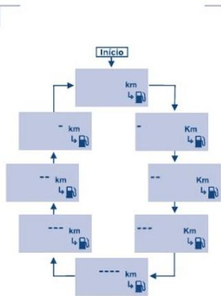
Este é o tempo necessário para que seja identificada a nova mistura de combustível, devido a isto, após o reabastecimento, os valores iniciais de autonomia indicados poderão variar.
