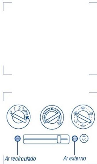
O ar condicionado liga automaticamente quando o controle de distribuição de ar for direcionado para a posição
