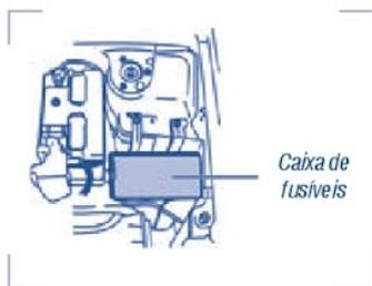
A caixa de fusíveis do compartimento do motor está localizada no lado direito do compartimento do motor junto à bateria.
