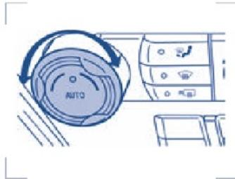
1. **AUTO**: para ajustar o controle automático de temperatura, pressione **AUTO** e selecione a temperatura desejada usando o controle de temperatura. O sistema determinará automaticamente a velocidade do ventilador, a distribuição do fluxo de ar, **A/C** ligado ou desligado, e ar externo ou recirculado, para aquecer ou refrigerar o veículo na temperatura desejada.
