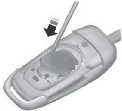
**Nota:** Não toque nos contatos da bateria ou na placa de circuito impresso com a chave de fenda.
