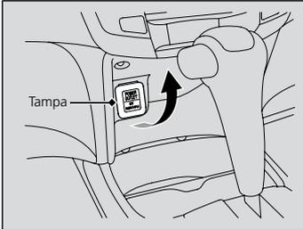
Há um soquete de alimentação para acessórios no painel do console dianteiro. Ele pode ser usado com o interruptor de ignição na posição **ACESSÓRIOS I** ou **LIGADA III**.
