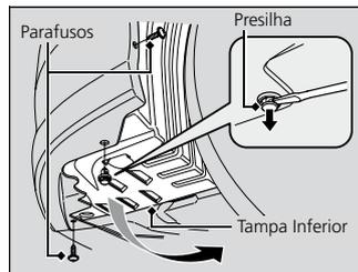
1. Remova os parafusos, usando uma chave de fenda Philips, e remova a presilha com uma chave de fenda comum.
