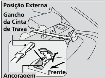
Existe um ponto de ancoragem atrás de cada uma das posições externas do banco traseiro. Para segurança adicional, utilize-o, juntamente com o cinto de segurança, se o sistema de proteção infantil estiver equipado com trava.
