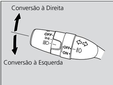
Os sinalizadores de direção poderão ser usados quando a chave de ignição estiver na posição **LIGADA III**.
