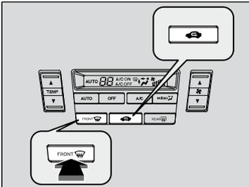
Quando pressionado, o interruptor **FRONT**
