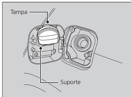
5. Remova lentamente a tampa do tanque de combustível. Se ouvir um chiado, aguarde até parar e gire lentamente a tampa para removê-la.
