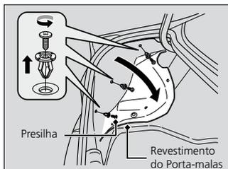
1. Remova os parafusos Philips das presilhas e puxe o revestimento para trás.
