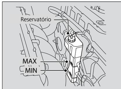
Depois que o motor tiver esfriado, inspecione o nível do líquido de arrefecimento e verifique se há vazamento nos componentes do sistema de arrefecimento.
