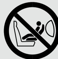
**NÃO coloque um sistema de proteção infantil voltado para trás neste banco equipado com airbag.**
