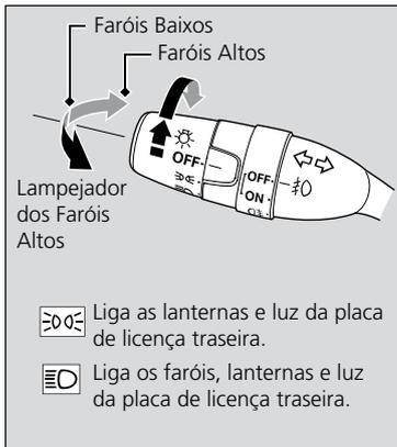
Girar o interruptor das luzes acende e apaga as luzes, independentemente da posição da chave de ignição.
