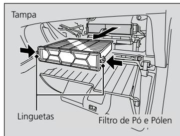
4. Desencaixe as duas linguetas, pressionando cada lado da tampa no painel do porta-luvas, e remova a tampa.
