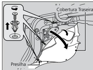
1. Remova o parafuso do centro de cada presilha, usando uma chave Philips e, em seguida, puxe a cobertura traseira.
