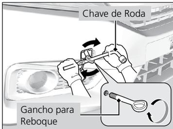
4. Parafuse o gancho para reboque no orifício e aperte-o firmemente com a chave de roda.
