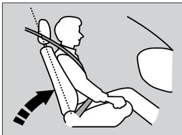
Ajuste o encosto do banco do motorista em uma posição ereta e confortável, deixando amplo espaço entre o seu tórax e a cobertura do airbag no centro do volante de direção.
