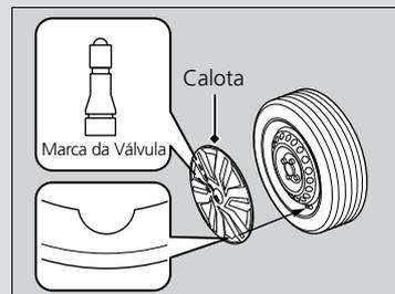
Certifique-se de que o ressalto do anel de sustentação está do lado de fora da válvula do pneu, conforme indicado na figura.
