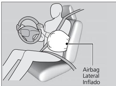
Quando os sensores detectam um impacto lateral moderado a severo, a unidade de controle sinaliza ao airbag lateral do lado do impacto para inflar imediatamente.
