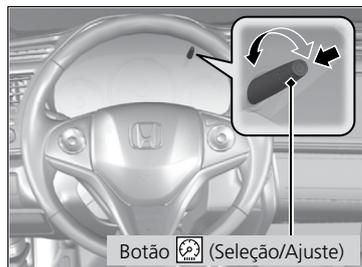
Quando as lanternas estiverem acesas e o interruptor de ignição estiver na posição **LIGADA III**, você pode usar o botão (Seleção/Ajuste) para ajustar a iluminação do painel de instrumentos.
