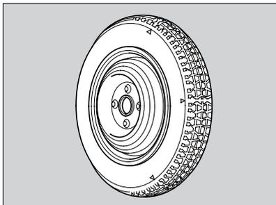
Use o estepe temporário (compacto) somente para substituição temporária. Leve o pneu-padrão para conserto ou substituição e instale-o novamente no veículo o mais rápido possível.
