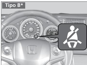
O seu veículo monitora o uso do cinto de segurança do motorista e do passageiro dianteiro. Se o interruptor de ignição estiver na posição **LIGADA III** e o motorista não estiver usando o cinto de segurança, um bipe soará e o indicador piscará. Se o motorista não colocar o cinto de segurança antes do bipe parar, o indicador permanecerá aceso.
