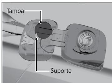
6. Coloque a tampa do tanque de combustível no suporte.
