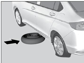
5. Coloque o estepe temporário (lado da roda para cima) embaixo da carroçaria do veículo, próximo ao pneu a ser substituído.
