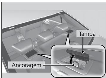
Existe um ponto de ancoragem atrás de cada uma das posições dos bancos traseiros laterais. Um sistema de proteção infantil instalado com cinto de segurança equipado com trava pode usá-lo para segurança adicional.
