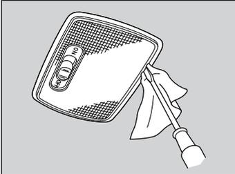
1. Usando uma chave de fenda, levante a borda da cobertura para remover a lente.
