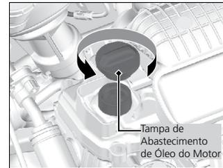
1. Desparafuse e remova a tampa de abastecimento de óleo do motor.
