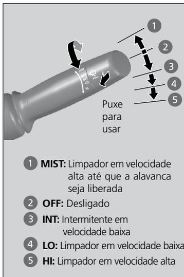
Os limpadores e lavadores podem ser usados quando o interruptor de ignição estiver na posição **LIGADA III**.
