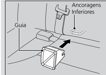
Quando não estiver usando as ancoragens inferiores, reposicione a cobertura das ancoragens inferiores entre o assento e o encosto do banco traseiro, de modo que a cobertura fique posicionada sobre as ancoragens inferiores.
