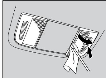
1. Pressione a lente do lado em que a lâmpada será substituída.
