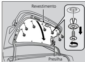
1. Remova o parafuso do centro de cada presilha, usando uma chave Philips e, em seguida, puxe o revestimento da tampa do porta-malas.
