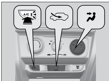
1. Ajuste a velocidade do ventilador usando o o botão de controle do ventilador.
