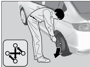
5. Abaixar o veículo e remover o macaco. Aperte as porcas da roda na ordem indicada pela figura. Aperte as porcas duas ou três vezes, conforme a seguir:
