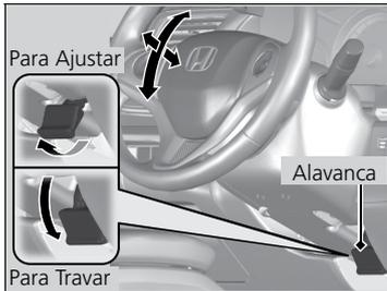
1. Puxe a alavanca de ajuste do volante de direção na sua direção.
