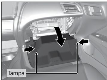
2. Desencaixe as duas linguetas pressionando cada painel lateral.
