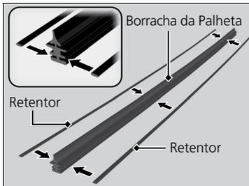
3. Deslize a palheta do limpador para fora do suporte, empurrando a extremidade da lingueta para fora.
