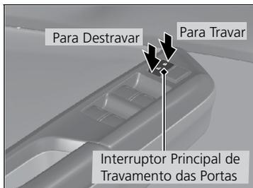
Pressione o interruptor principal de travamento das portas, conforme indicado, para travar ou destravar todas as portas.
