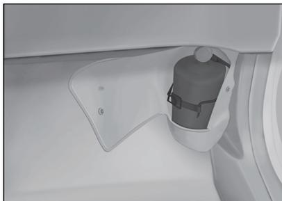
Caso deseje instalar o extintor de incêndio, o local ideal para sua instalação é sob o painel de instrumentos, no lado do passageiro dianteiro, fixado a carroceria do veículo.
