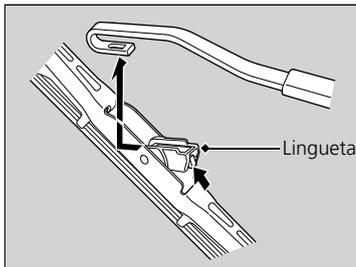
2. Pressione a lingueta da trava e, em seguida, deslize a palheta da haste do limpador.
