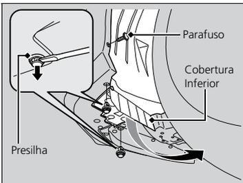
1. Remova o parafuso, usando uma chave Philips.
