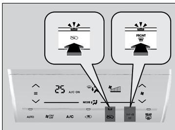
Ao selecionar o ícone
