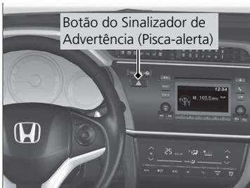
Pressione o botão localizado à esquerda do sistema de áudio, no painel de instrumentos, para acionar o sinalizador de advertência. Todos os sinalizadores externos e luzes indicadoras no painel de instrumentos pisarão, enquanto o sinalizador de advertência permanecer acionado. Para desligar, pressione o botão novamente.
