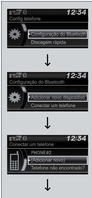
■ **Parear um telefone (Quando um telefone já tiver sido pareado com o sistema)**
