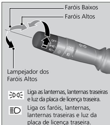
Ao girar o interruptor das luzes, as luzes se acendem e se apagam, independentemente da posição do interruptor de ignição.
