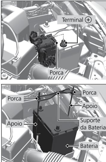
5. Afrouxe a porca no cabo positivo da bateria e, em seguida, desconecte o cabo do terminal positivo (+).
