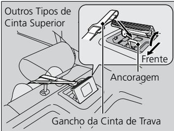
5. Levante o encosto de cabeça para a posição mais elevada e, em seguida, passe a cinta de trava entre as hastes do encosto de cabeça, fixando o gancho da cinta na ancoragem. Certifique-se de que a cinta não esteja torcida.
