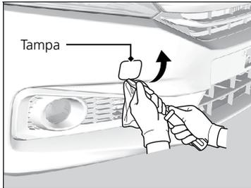
2. Coloque um pano na borda da tampa. Pressione cuidadosamente usando uma chave de fenda pequena para remover a tampa.
