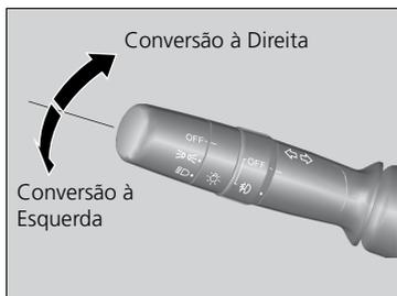
Os sinalizadores de direção poderão ser usados quando o interruptor de ignição estiver na posição **LIGADA III**.
