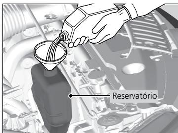
2. Se o nível do líquido de arrefecimento estiver abaixo da marca **MIN**, adicione o líquido de arrefecimento especificado até atingir a marca **MAX**.
