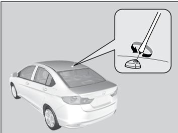
Seu veículo está equipado com uma antena removível no teto.
