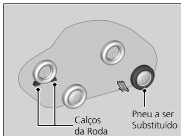
4. Coloque um calço na frente e atrás da roda diagonalmente oposta ao pneu furado.
