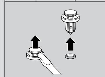
Insira a presilha com o pino central levantado e pressione-o até que fique nivelado.
