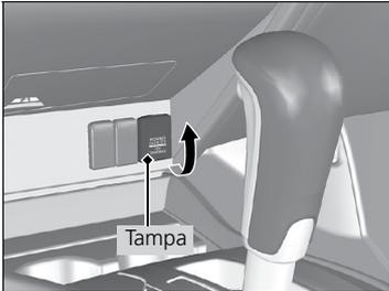
O soquete de alimentação de acessórios pode ser usado quando o interruptor de ignição estiver na posição **ACESSÓRIOS** **I** ou **LIGADA** **III**.
