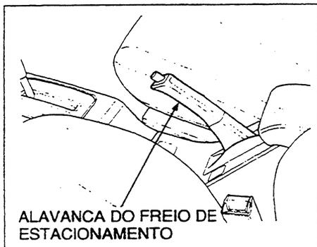
Para acionar o freio de estacionamento, puxe a alavanca totalmente para cima. Para soltá-lo, puxe a alavanca ligeiramente para cima, pressione o botão e abaixe a alavanca. A luz de advertência no painel irá apagar quando o freio de estacionamento estiver totalmente solto.
