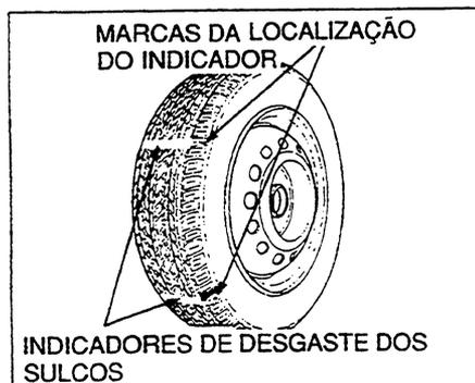
A Honda recomenda a substituição de quatro pneus em conjunto ou em pares, dianteira e traseira.
