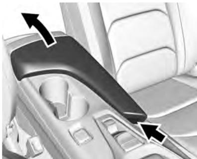
Pressione para abrir. Há uma porta USB e uma tomada auxiliar dentro. Consulte o manual do sistema de conforto e conveniência.
