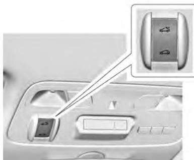
Se equipado, o teto solar funciona somente quando a ignição estiver em on (ligada) ou em ACC/ACCESSORY, ou quando a energia retida para acessórios (RAP) estiver ativa. Consulte *Energia retida de acessório (RAP)* ⇨ 167.
