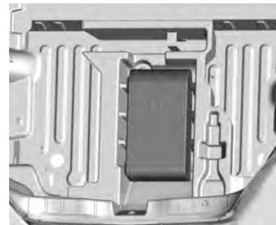
3. Remova a bolsa do kit do composto de vedação para pneu e o compressor da espuma de armazenamento.
