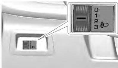
O controle manual do nivelamento dos faróis está no lado de fora da coluna de direção. Esta função permite que o nível dos faróis seja ajustado para se adequar à carga do veículo. O ajuste correto do nivelamento dos faróis pode reduzir o ofuscamentos dos outros motoristas.
