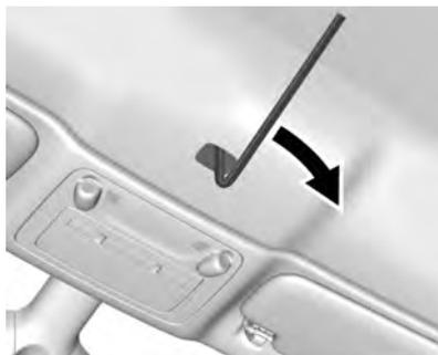
3. Trave a parte da frente da capota conversível na estrutura retirando a cobertura pequena, inserindo uma chave hexagonal e girando no sentido horário até que pare.
