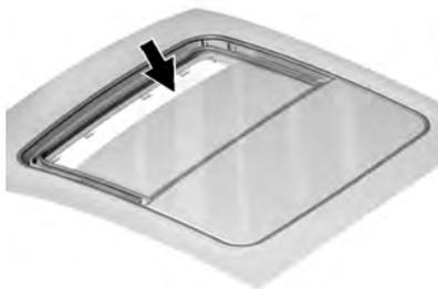
A sujeira e detritos podem se acumular na vedação do teto solar ou no trilho. Isto poderá causar um problema no funcionamento ou ruído no teto solar. Isto também poderá obstruir o sistema de drenagem de água. Abra periodicamente o teto solar e remova qualquer obstáculo ou detrito solto. Limpe a vedação do teto solar e a área de vedação usando um pano limpo, sabão suave e água. Não remova a graxa do teto solar.
