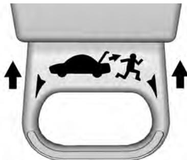
Depois de puxar a alavanca de abertura de emergência do porta-malas, empurre-a de volta para o bisel.
