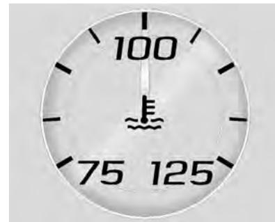
Este medidor exibe a temperatura do líquido de arrefecimento do motor.
