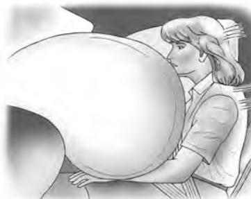
O airbag do passageiro dianteiro externo está no painel de instrumentos do lado do passageiro.
