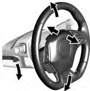
Para ajustar o volante telescópico e a inclinação:
