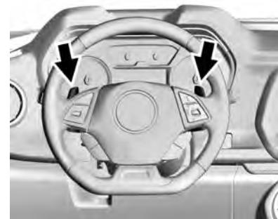
O câmbio TAP permite que o motorista controle manualmente a transmissão automática. Para usar o câmbio TAP, a alavanca de marchas deve estar no modo DSC. Veículos com esse recurso possuem indicadores no volante. As alavancas estão na parte posterior do volante. Toque na alavanca esquerda (-) para reduzir e na alavanca direita (+) para passar para uma marcha superior. O visor do Centro de Informações do Motorista indica a marcha em que o veículo está.
