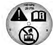
1. Remova a tampa de pressão do reservatório de expansão do líquido de arrefecimento da câmara superior quando o sistema de arrefecimento, inclusive a tampa de pressão do reservatório e a mangueira superior do radiador, não estiver mais quente.
