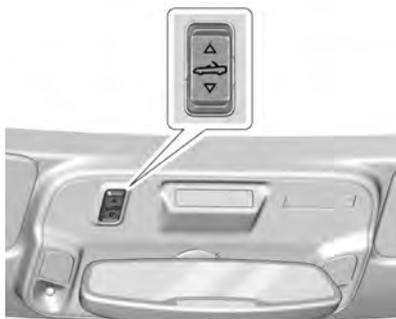
5. Pressione e solte a parte de baixo de . Os vidros abrirão automaticamente.
