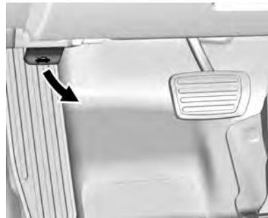
1. Puxe a alavanca de liberação abaixo do painel de instrumentos, à esquerda do volante, em frente ao apoio para os pés.
