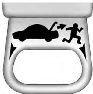
Há uma alavanca de abertura de emergência do porta-malas, que brilha no escuro, na tampa do porta-malas. Esta alça brilhará de acordo com a exposição à luz. Puxe a alavanca de abertura para abrir o porta-malas por dentro.
