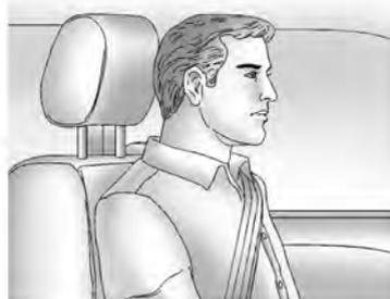
Ajuste o apoio de cabeça de forma que a parte superior do apoio fique na mesma altura da parte superior da cabeça do ocupante. Essa posição reduz a probabilidade de lesão do pescoço em caso de colisão.
