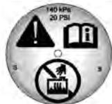
1. Remova a tampa de pressão do reservatório de expansão do líquido de arrefecimento da câmara superior quando o sistema de arrefecimento, inclusive a tampa de pressão do reservatório e a mangueira superior do radiador, não estiver mais quente.
