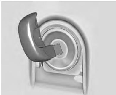
5. Remova qualquer outro item acoplado à chave - como chaves, anéis ou chaveiros - e então insira completamente a chave na liberação manual.
