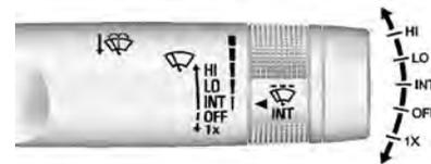
A alavanca do lavador / limpador do para-brisa está à direita da coluna da direção. Com a ignição ligada ou em ACC / ACCESSORY, mova
