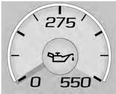
O medidor de pressão do óleo do motor mostra a pressão do óleo do motor em kPa (quilopascal) quando o motor está ligado.
