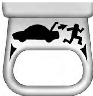
Há uma alavanca de abertura de emergência do porta-malas, que brilha no escuro, na tampa do porta-malas. Esta alça brilhará de acordo com a exposição à luz. Puxe a alavanca de abertura para abrir o porta-malas por dentro.
