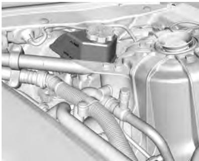
Com o veículo em P (Parado) e sobre uma superfície plana, o nível do fluido de freios deve ficar entre as marcas MIN e MAX no reservatório do fluido de freios.
