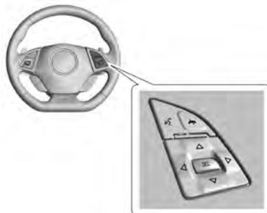
Use o comando no lado direito do volante para abrir e rolar pelos diferentes itens e exibições.
