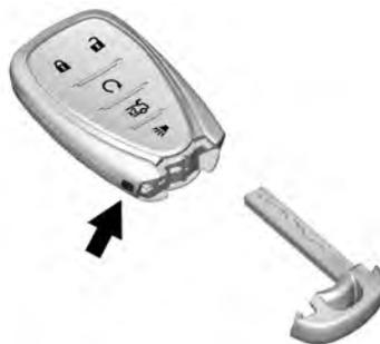
Pressione o botão de liberação da chave próximo à parte inferior do transmissor RKE para remover a chave. Nunca puxe a chave para fora sem pressionar o botão. A chave pode ser usada para todas as travas.
