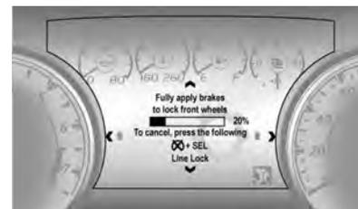
6. Pressione o pedal do freio com firmeza para mover o gráfico de barras para 100%.
