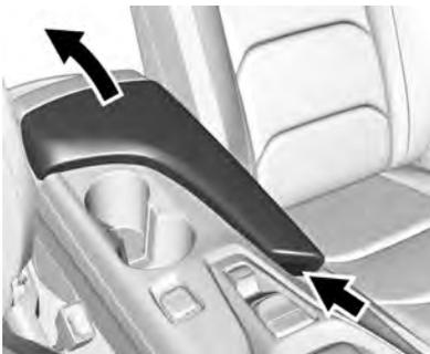
Pressione para abrir. Existem duas portas USB e uma tomada auxiliar na parte interna. Consulte o manual do sistema de conforto e conveniência.
