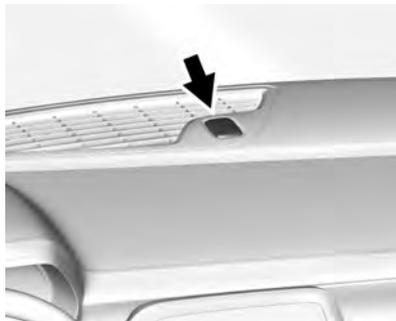
A luz de segurança, no painel de instrumentos próximo do para-brisa, indica o status do sistema:
