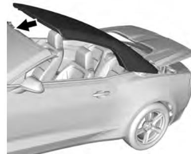
2. Levante e mova a capota conversível para a frente puxando dos dois lados do arco dianteiro para a posição completamente fechada.
