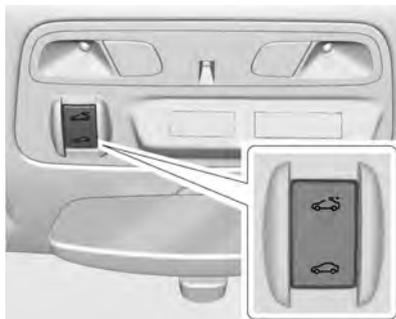
Se equipado, o teto solar funciona somente quando a ignição estiver em on (ligada) ou em ACC / ACCESSORY, ou quando a energia retida para acessórios (RAP) estiver ativa. Consulte *Energia retida de acessório (RAP)* ⇨ 177.
