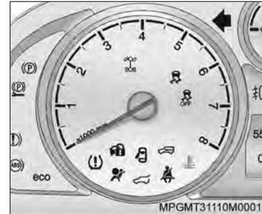
Se for notada alguma irregularidade na temperatura do motor — se, por exemplo, a luz indicadora se acender, consulte "Superaquecimento do motor", na Seção 9.
