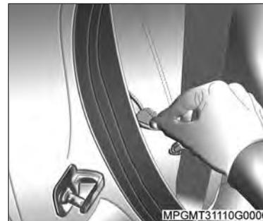
1. Puxe o cordão elástico que fica entre a borda do encosto do banco e a lateral interna para remover a guia de seu local de armazenamento.
