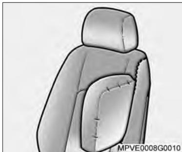
A velocidade, a direção do movimento e a deformação do veículo, além do obstáculo atingido, determinam a severidade do acidente e o acionamento ou não do "Air bag" lateral.
