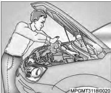
**⚠ Atenção!** Os vapores e líquidos escaldantes provenientes do sistema de arrefecimento em ebulição podem explodir e causar queimaduras graves. Eles estão sob pressão, e se a tampa do radiador for aberta mesmo que parcialmente, os vapores poderão ser expelidos a alta velocidade. Nunca gire a tampa do radiador enquanto o motor e o sistema de arrefecimento estiverem quentes. Se houver necessidade de girar a tampa, espere o motor esfriar.
