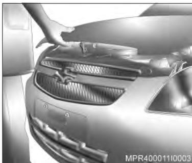
Para abrir completamente, levante o capô com uma das mãos e com a outra, levante a trava do trinco de segurança, localizada ligeiramente à esquerda, a partir do centro, quando vista pela parte dianteira do veículo.
