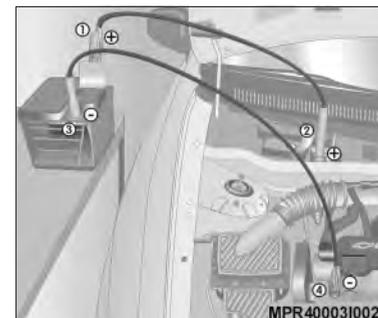
5. Conecte os terminais na sequência indicada:
