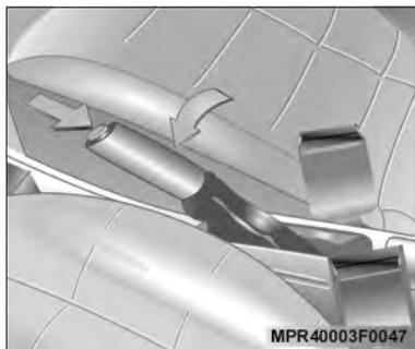
Para liberação do freio de estacionamento, force levemente a alavanca para cima, comprima o botão na extremidade da alavanca (seta) e empurre-a para baixo até que a luz indicadora (D) do painel se apague.
