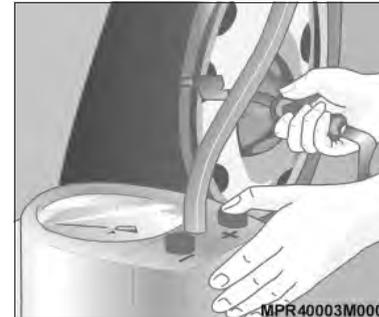
Após a verificação da pressão dos pneus, coloque novamente as tampas de proteção das válvulas dos bicos de enchimento.
