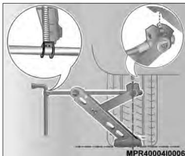
8. Posicione o braço do macaco no encaixe mais próximo da roda a ser substituída, de modo que a garra do macaco envolva a lâmina vertical e encaixe no rebaixo da lâmina.
