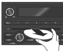
Para ejetar o disco, pressione o botão EJECT para remover o disco.
