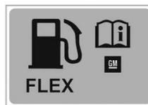
A etiqueta adesiva acima contém uma indicação do tipo de combustível e se localiza na portinhola do bocal de enchimento de combustível do veículo.
