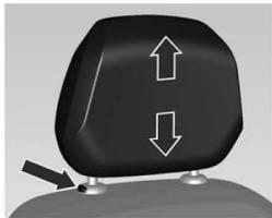
Para ajustar a altura, puxe o apoio de cabeça para cima. Para mover para baixo, pressione o botão de travamento e empurre o apoio de cabeça para baixo.
