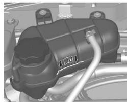
Se o sistema de resfriamento estiver frio, o nível do líquido de arrefecimento deve estar acima da marca de enchimento. Complete se o nível estiver baixo. Portanto, adicione ao tanque de expansão uma mistura de água potável e aditivo para radiador (longa duração - cor laranja) ACDelco (proporção de 35% a 50% de aditivo).
