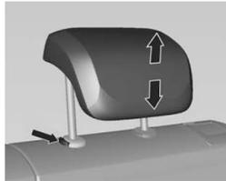
Puxe o apoio de cabeça para cima. Para mover para baixo, pressione o botão de travamento e empurre o apoio de cabeça para baixo.
