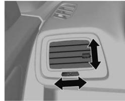
Para abrir os difusores laterais, vire as aletas para cima e a roda do ajustador para a esquerda e direita até que a direção desejada seja atingida.
