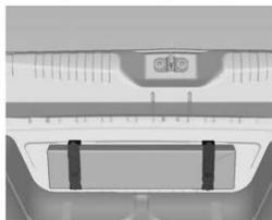
O triângulo de segurança pode ser guardado debaixo do piso do compartimento de carga na parede do compartimento de carga. Fixe o triângulo de segurança com as correias de borracha em ambos os lados.
