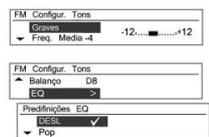
No menu de configuração de tom, recursos de som podem ser configurados diferentemente de acordo com as funções de áudio FM/AM e de cada reproduzidor de áudio. Pressione o botão **TONE** ao usar o modo de funcionamento relevante. Gire o botão de controle **MENU-TUNE** para selecionar o modo de controle de tom desejado e, a seguir, pressione o botão **MENU-TUNE**.
