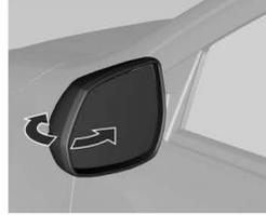
Para segurança do pedestre, os espelhos externos saíram da posição de montagem normal caso alguém colida com eles com força suficiente para isso. Reposicione o espelho ao aplicar uma leve pressão na caixa do espelho. Essa função é também útil para reduzir a largura total do veículo e evitar danos quando o veículo estiver estacionado. Coloque o espelho de volta na posição funcional antes de dirigir.
