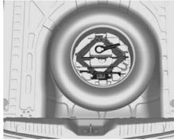
O macaco e as ferramentas estão em um compartimento de armazenamento no compartimento de carga embaixo do pneu reserva. Pneu reserva ⇨ 204.
