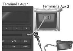
■ O sistema de Conforto e conveniência alternará automaticamente para o modo de entrada de som externo (AUX) quando o dispositivo de som externo for conectado.
