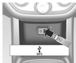
Abaixo do painel de instrumentos, há uma porta de conexão para dispositivos de armazenamento USB com arquivos de música para serem reproduzidos pelo terminal de conexão USB.
