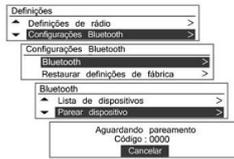
Pressione o botão **CONFIG** e use o botão **MENU-TUNE** com o botão de controle para mover para Configuração do sistema → Configurações Bluetooth → Bluetooth → Parear dispositivo e, a seguir, pressione o botão **MENU-TUNE**.
