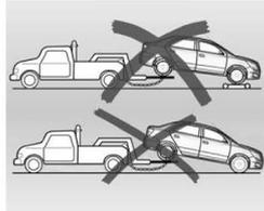
A rebocagem em 2 rodas não é adequada para este veículo.
