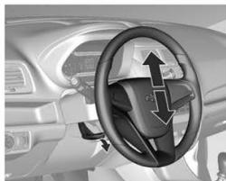
Destrave a alavanca, ajuste o volante e trave-a novamente, e assegure-se de que esteja totalmente travada. Regule o volante apenas quando o veículo estiver parado e a coluna de direção destravada.
