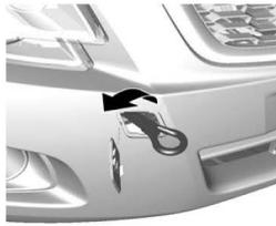
Aparafuse o gancho de emergência apertando-o ao máximo, até que pare em uma posição horizontal. Será mais fácil se a chave de roda for usada para nivelar.
