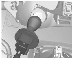
2. Desconecte a tomada de conexão da lâmpada.
