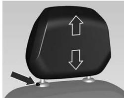
Puxe o apoio de cabeça para cima. Para mover para baixo, pressione o botão de travamento e empurre o apoio de cabeça para baixo.
