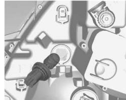
3. Desconecte a tomada de conexão da lâmpada.
