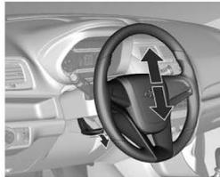
Destrave a alavanca, ajuste o volante e trave-a novamente, e assegure-se de que esteja totalmente travada. Não ajuste o volante a menos que o veículo esteja parado.
