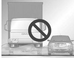
Se realmente for preciso atravessar um trecho alagado, fazê-lo sempre em baixa velocidade, em torno de 10 km/h, utilizando a primeira marcha.
