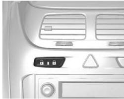
O LED de status é integrado com o botão central de travamento, próximo ao centro do painel de instrumentos.
