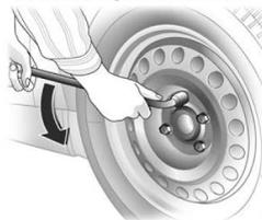
Instale a chave de roda assegurando-se de que ela esteja assentada de forma segura e afrouxe cada parafuso meia volta.
