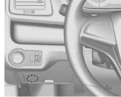
A caixa de fusíveis está localizada no lado esquerdo do painel de instrumentos. Remova a tampa para acessar a caixa de fusíveis.
