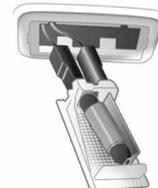
2. Pressione a lâmpada ligeiramente na direção do clipe de mola e remova-a.
