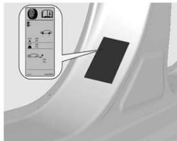
Pressão dos pneus ⇨ 233 na etiqueta da moldura da porta dianteira esquerda.
