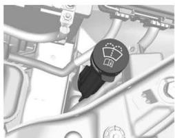
Encha com água limpa misturada com uma quantidade adequada de aditivo para limpeza de para-brisa.
