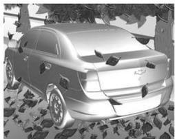
Evite estacionar ou manter o veículo sobre capim seco, arbustos, respingos de combustível e outros materiais inflamáveis quando o sistema de descarga estiver aquecido. Dependendo da situação, isto pode causar um princípio de incêndio.
