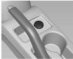
Uma tomada de energia de 12 Volts está localizada no console central. Não exceda o consumo máximo de potência de 120 Watts. A tomada é desativada com a ignição desligada. Adicionalmente, a tomada é desativada no caso de baixa tensão da bateria.
