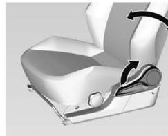
Puxe a alavanca, ajuste a inclinação e solte a alavanca. Deixe o banco engatar de forma audível.
