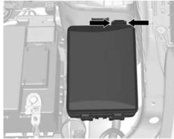
A caixa de fusíveis está localizada na parte dianteira esquerda do compartimento do motor.
