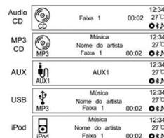
Pressione repetidamente o botão **CD/AUX** para alternar entre as funções do reprodutor de áudio, a função **AUX** para discos CD/MP3 ou o reprodutor de áudio conectado **USB, iPod** ou **Bluetooth**. (CD/MP3 → AUX → USB ou **Bluetooth** audio → CD/MP3 →...)
