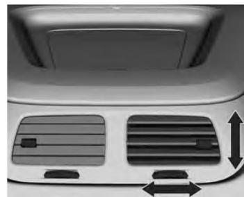
Direcione o fluxo de ar inclinando as aletas e a roda do ajustador.
