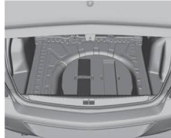
O triângulo de segurança está guardado debaixo do piso do compartimento de carga na base do pneu reserva.
