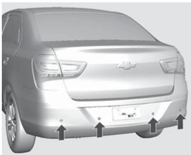
O sistema auxiliar de estacionamento facilita o estacionamento medindo a distância entre o veículo e os obstáculos traseiros e fornecendo sinais sonoros. É o motorista, no entanto, que tem total responsabilidade pela manobra de estacionamento.
