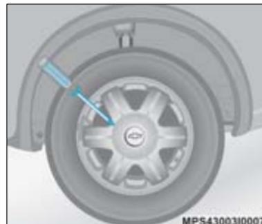
6. (Roda de alumínio) Remova a calota central com auxílio de uma chave de fenda.
