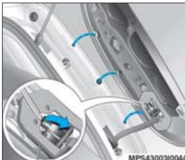
3. Retire a conexão, usando uma chave de fenda e desencaixe-a do suporte de lâmpadas.
