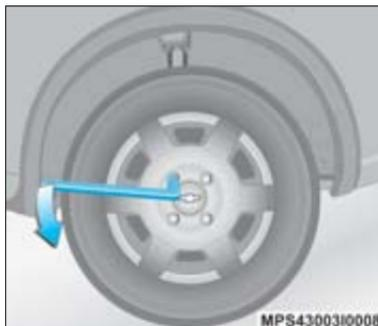
7. (Roda com calota integral e de alumínio) Com a chave de roda, afrouxe os parafusos meia a uma volta; não os remova.
