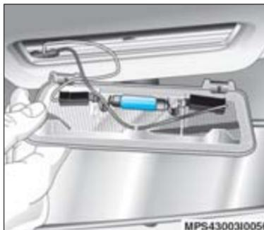
2. Pressione levemente a lâmpada contra o terminal e retire-a.
